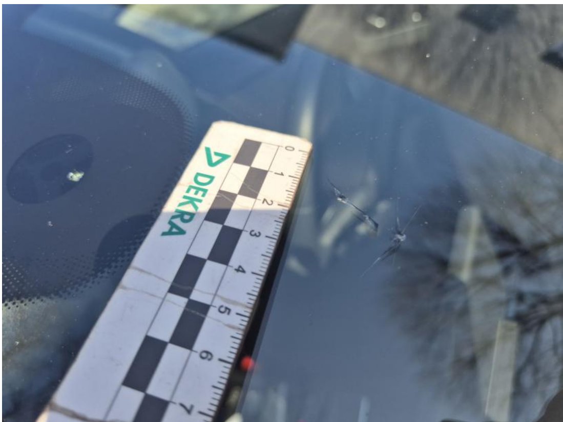
Fot. 32 Szyba czołowa - Pęknięcie/rozerwanie 1
