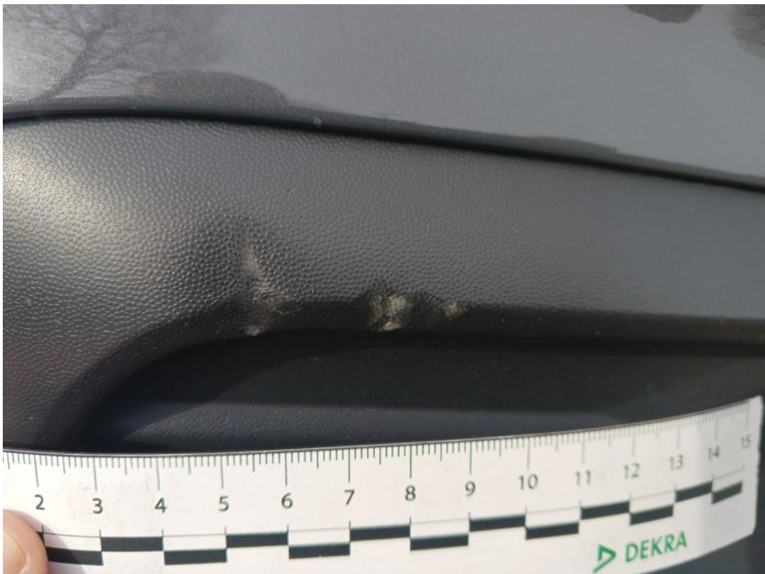
Fot. 36 Kratka/zaślepka halogenu P - Wgniecenie/odkształcenie 1
