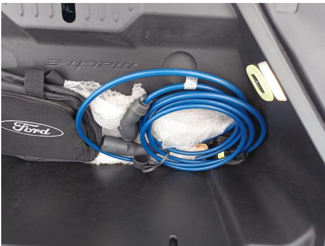
Fot. 28 Przewód ładowania baterii trakcyjnej
