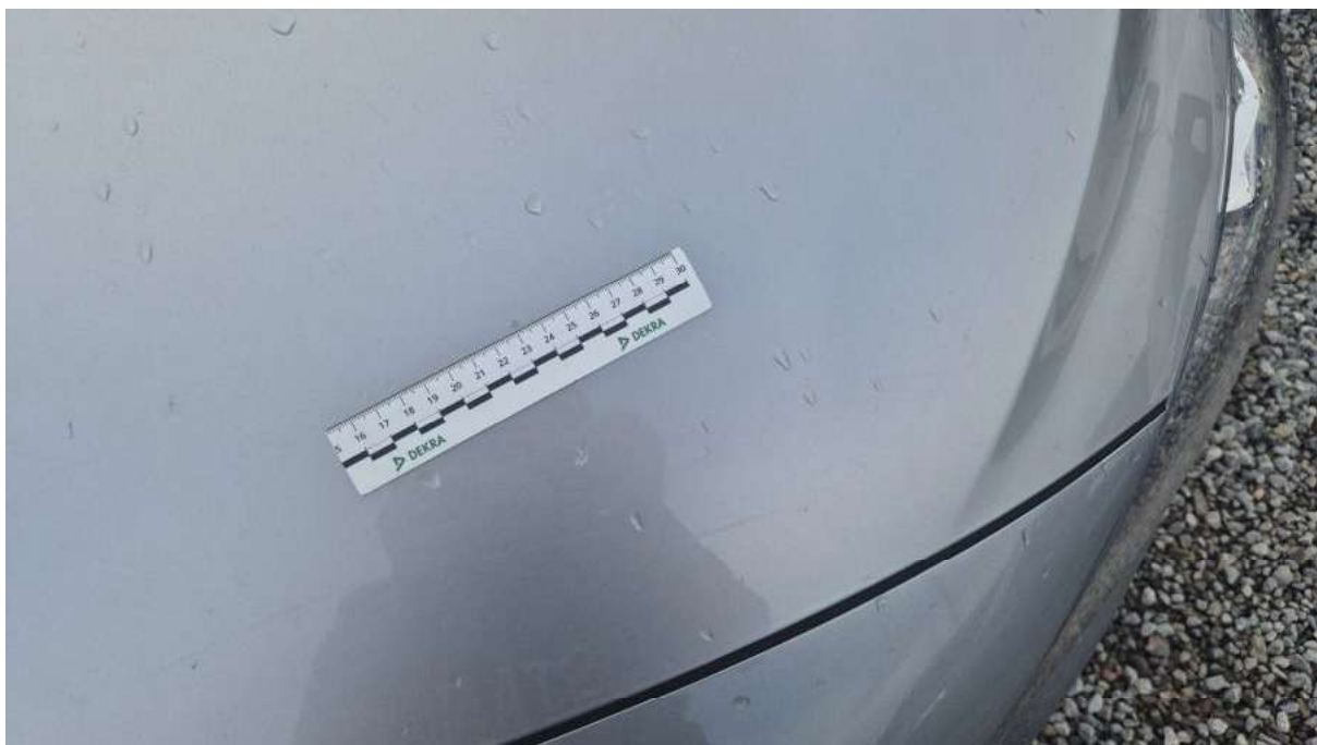
Fot. 38 Pokrywa komory silnika - Rysa/odprysk 1
