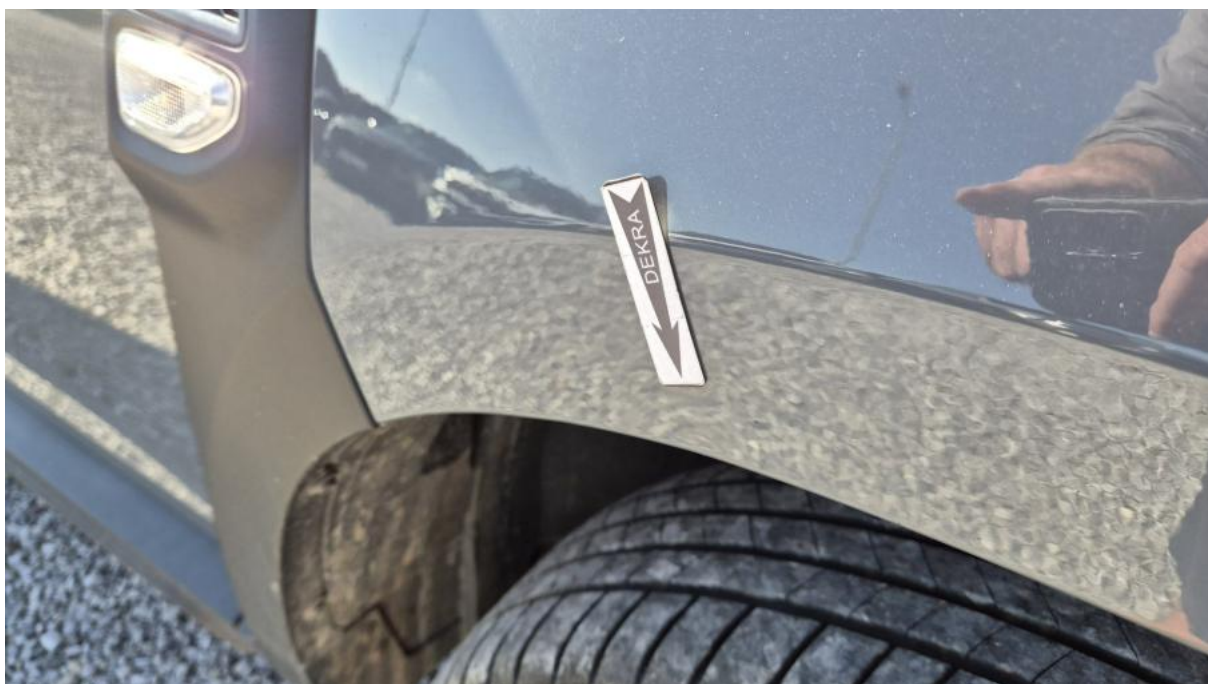
Fot. 38 Błotnik przedni P - Wgniecenie/odkształcenie 1
