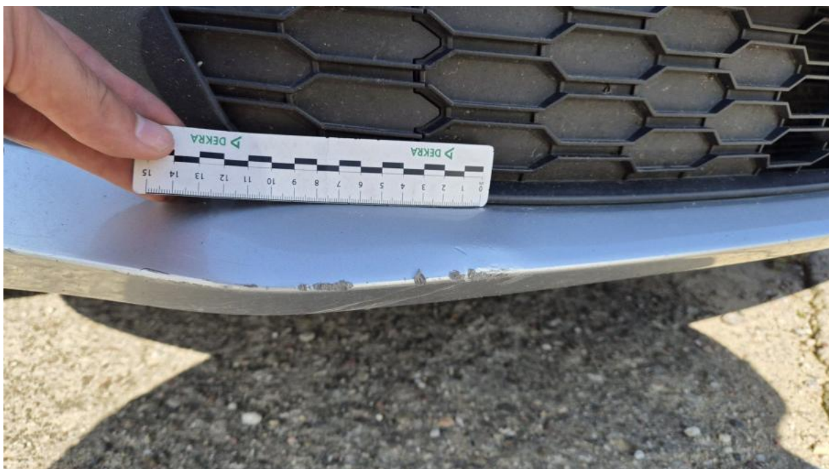
Fot. 36 Zderzak - Wgniecenie/odkształcenie 1
