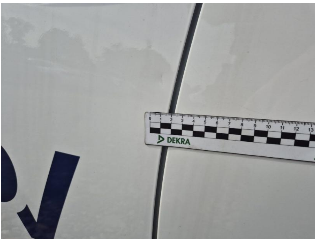
Fot. 34 Drzwi przed L - Wgniecenie/odkształcenie 1
