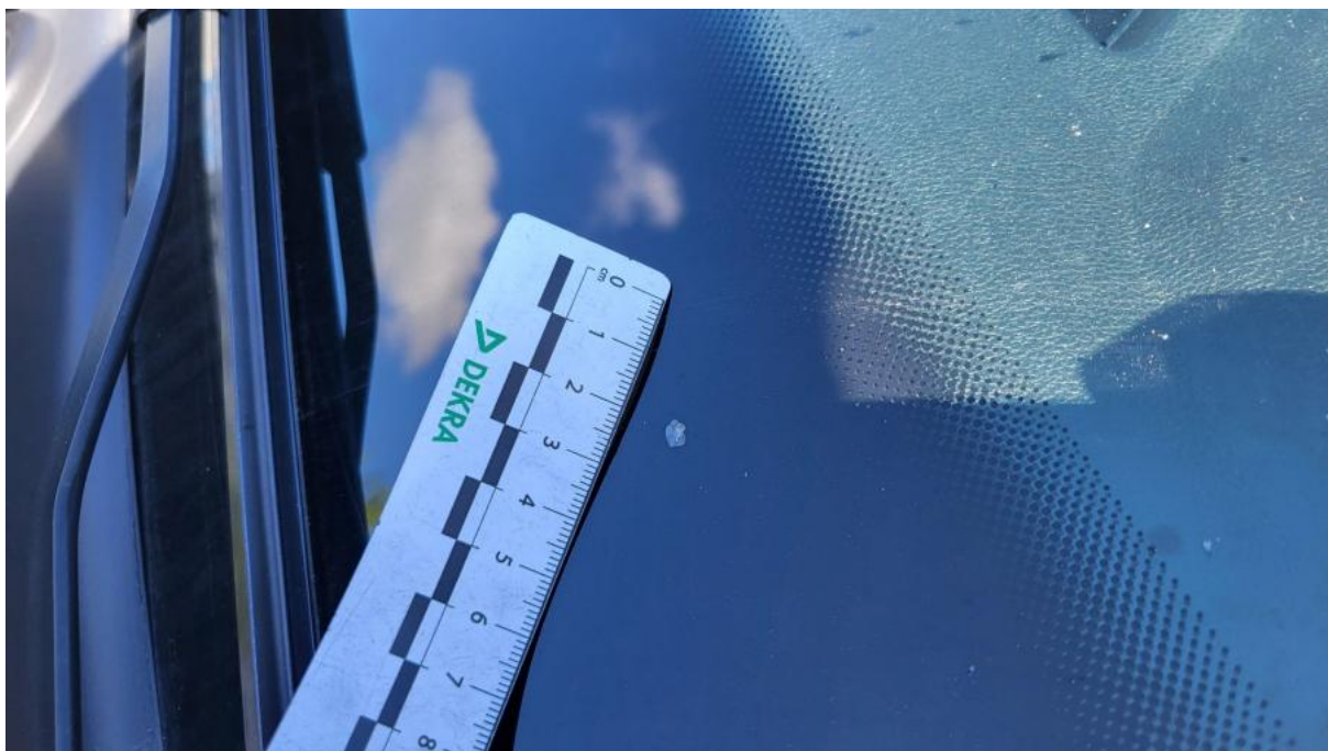
Fot. 38 Szyba czołowa - Pęknięcie/rozerwanie 1
