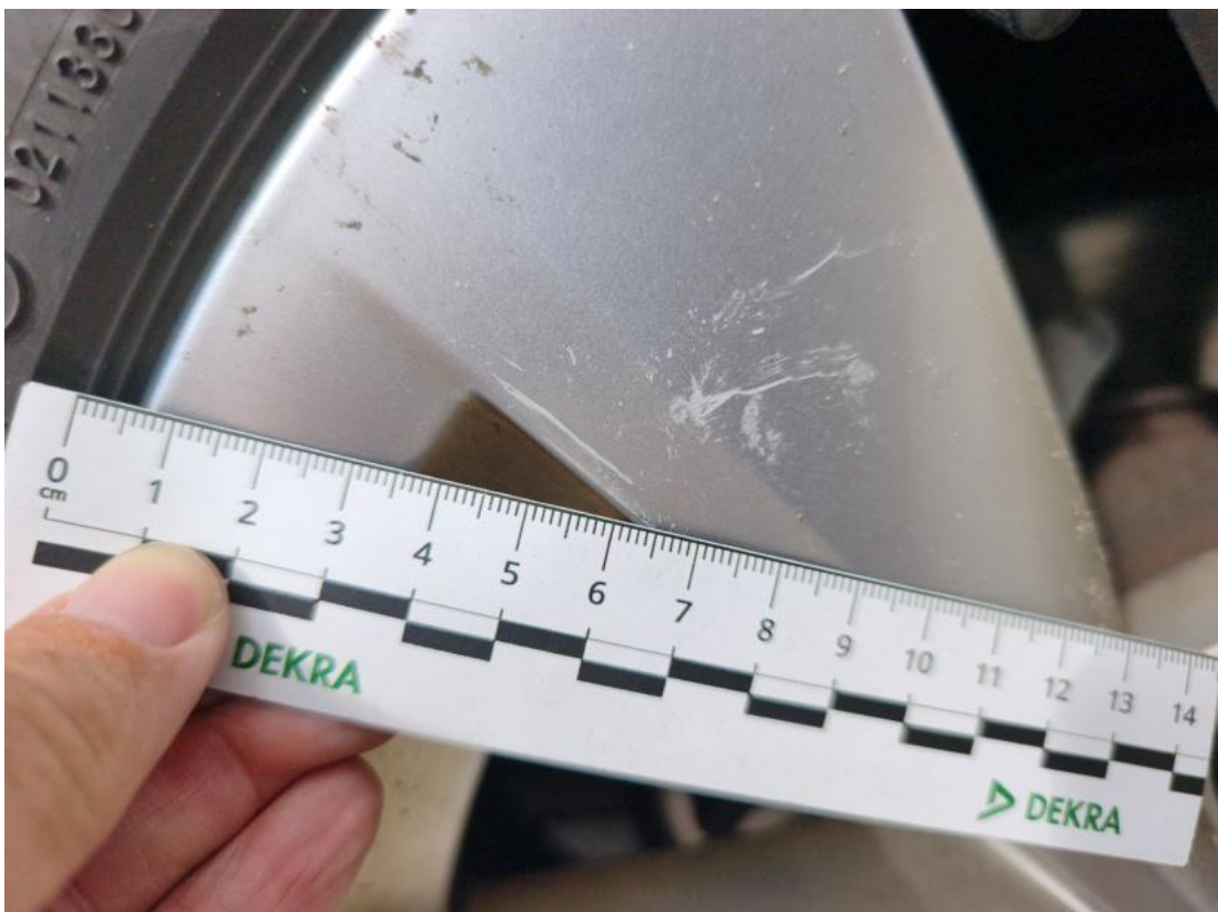
Fot. 56 Felga aluminiowa tylna L - Rysa/odprysk 1
