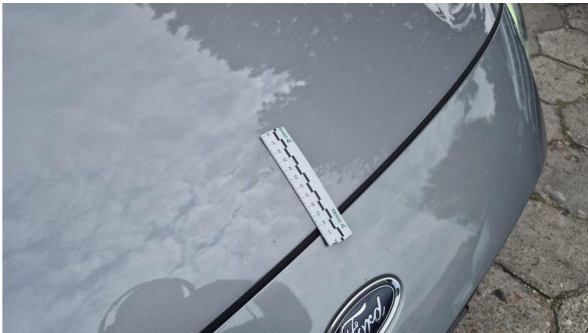
Fot. 38 Pokrywa komory silnika - Rysa/odprysk 1
