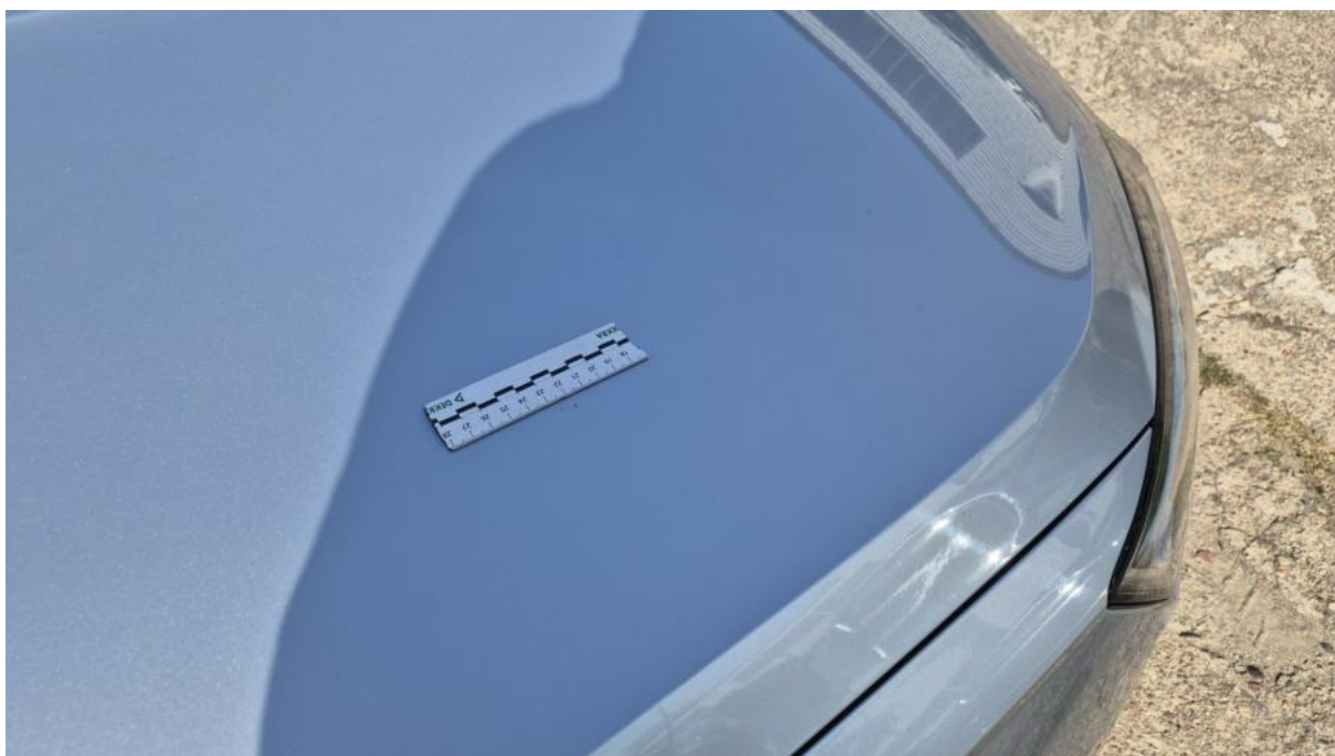
Fot. 38 Pokrywa komory silnika - Rysa/odprysk 1
