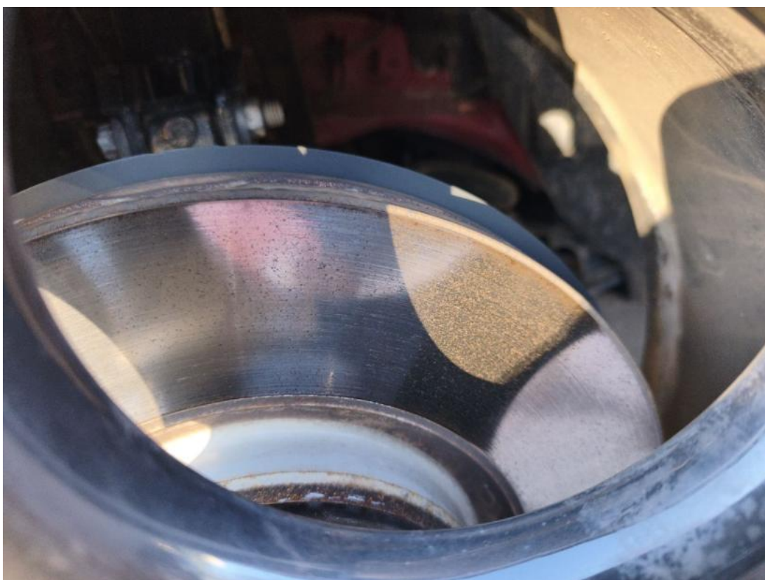
Fot. 28 Tarcza hamulcowa przednia lewa
