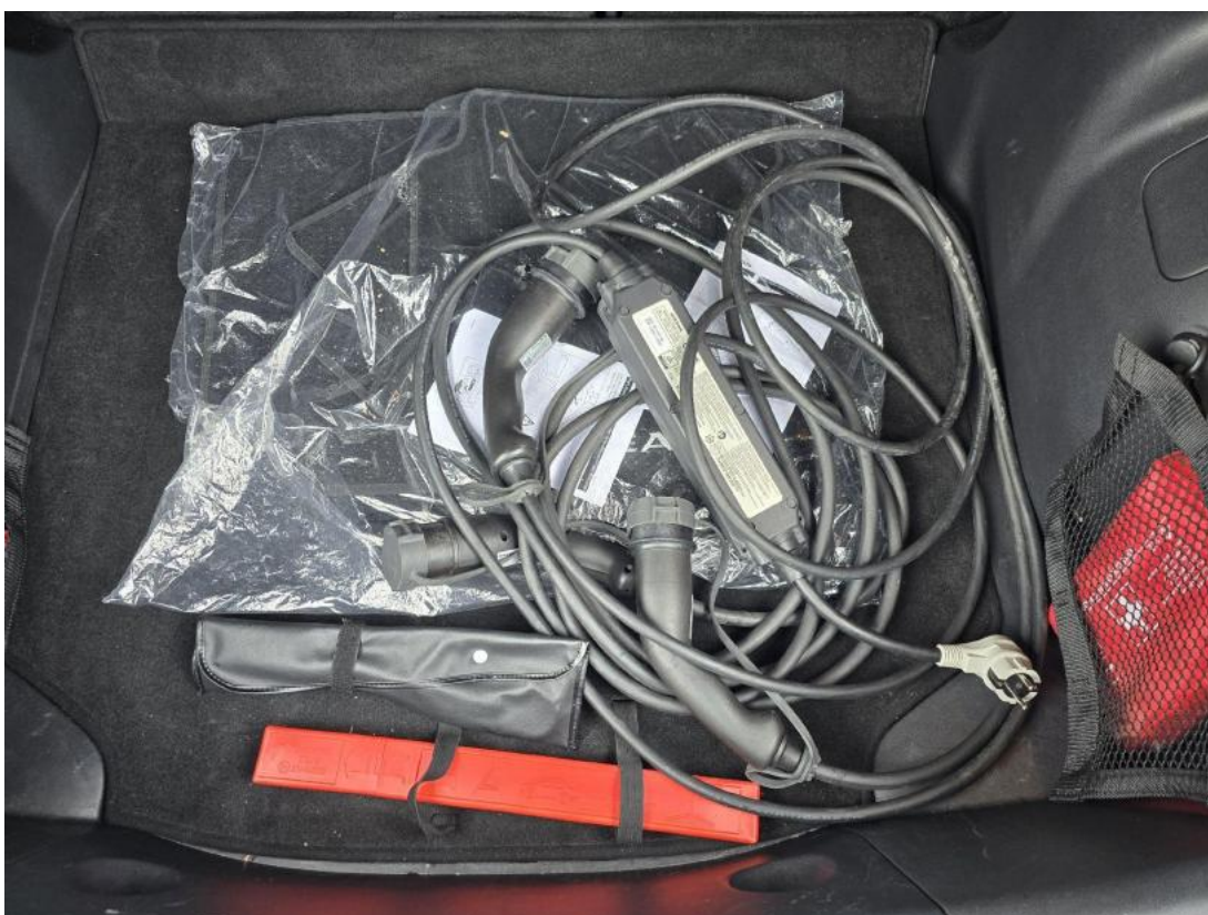
Fot. 28 Przewód ładowania baterii trakcyjnej
