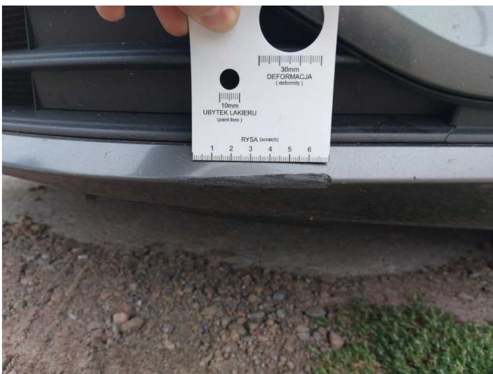
Fot. 62. Zderzak lakier. PRZ() - zarysowanie 3
