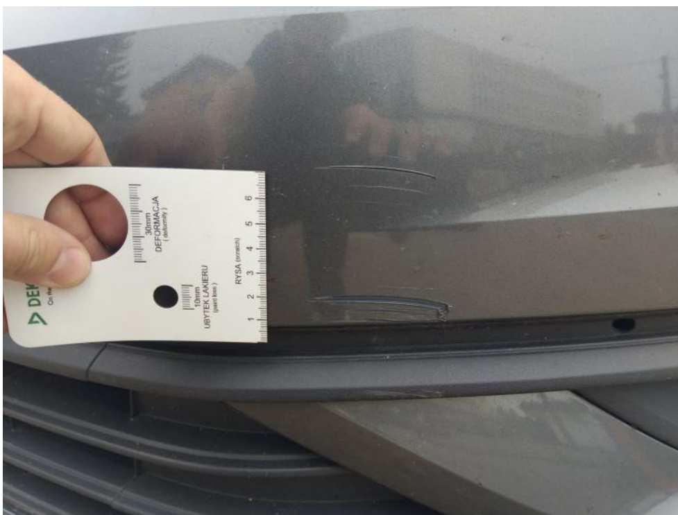
Fot. 61. Zderzak lakier. PRZ - zarysowanie 2
