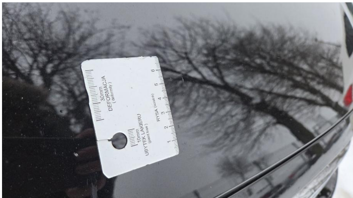
Fot. 32 Pokrywa komory silnika - Wgniecenie/odkształcenie 1
