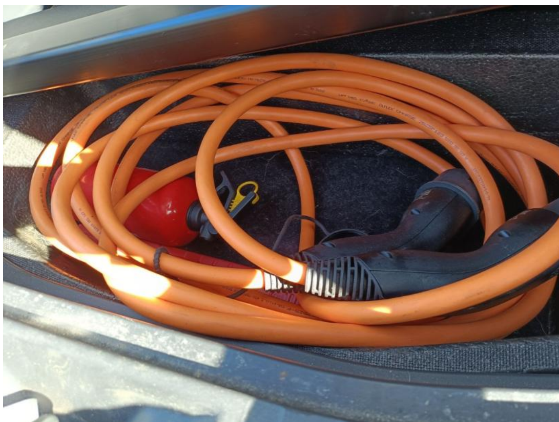
Fot. 28 Przewód ładowania baterii trakcyjnej
