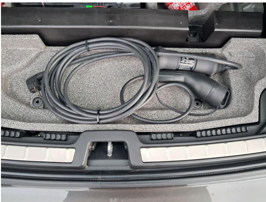
Fot. 28 Przewód ładowania baterii trakcyjnej
