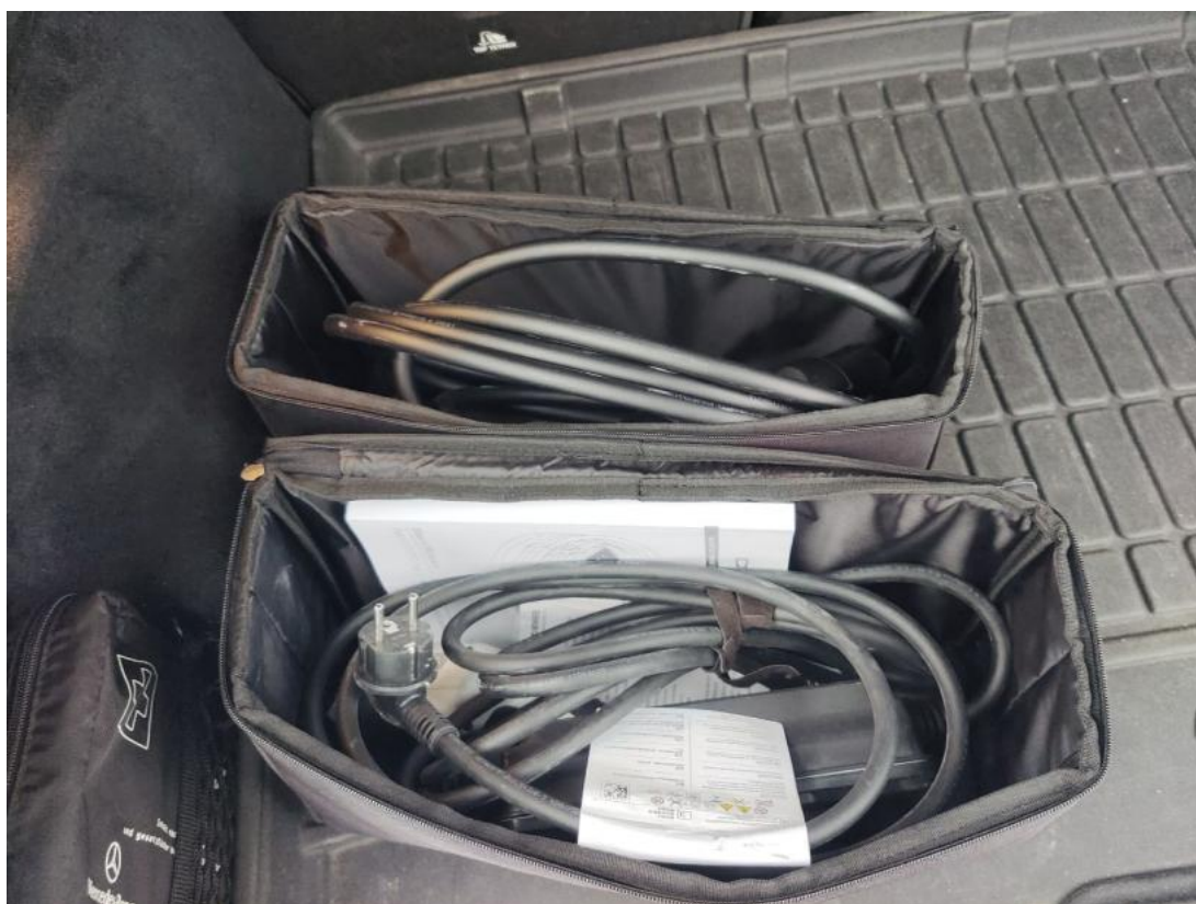
Fot. 28 Przewód ładowania baterii trakcyjnej
