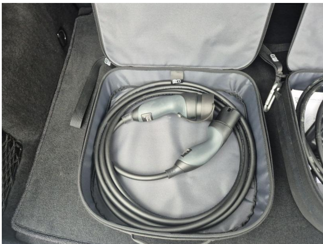
Fot. 28 Przewód ładowania baterii trakcyjnej
