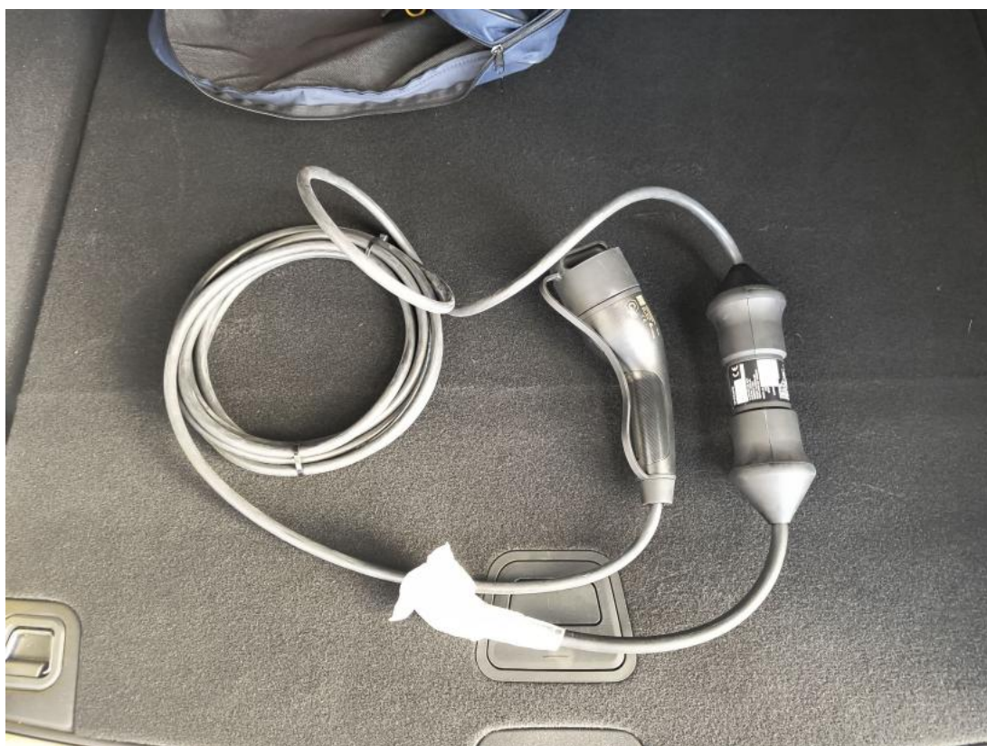
Fot. 28 Przewód ładowania baterii trakcyjnej
