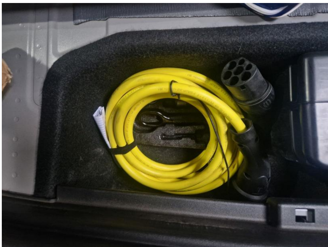
Fot. 28 Przewód ładowania baterii trakcyjnej
