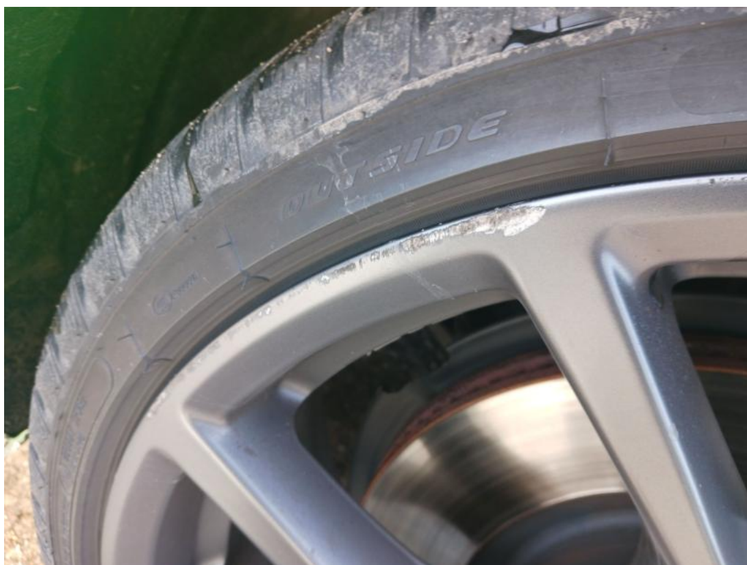
Fot. 38 Felga aluminiowa przednia P - Rysa/odprysk 1
