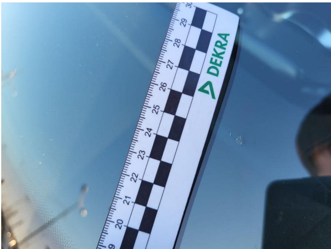
Fot. 36 Szyba czołowa - Rysa/odprysk 1
