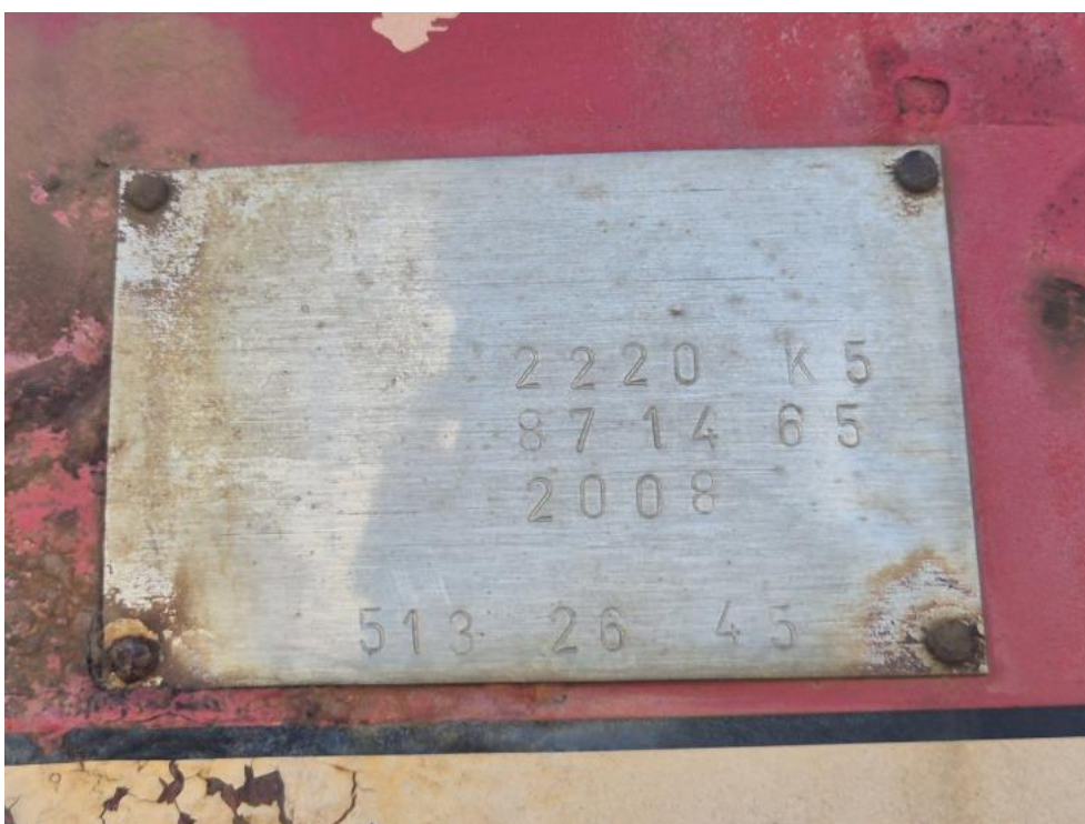
Fot. 32. Tabliczka znamionowa żurawia hydr.
