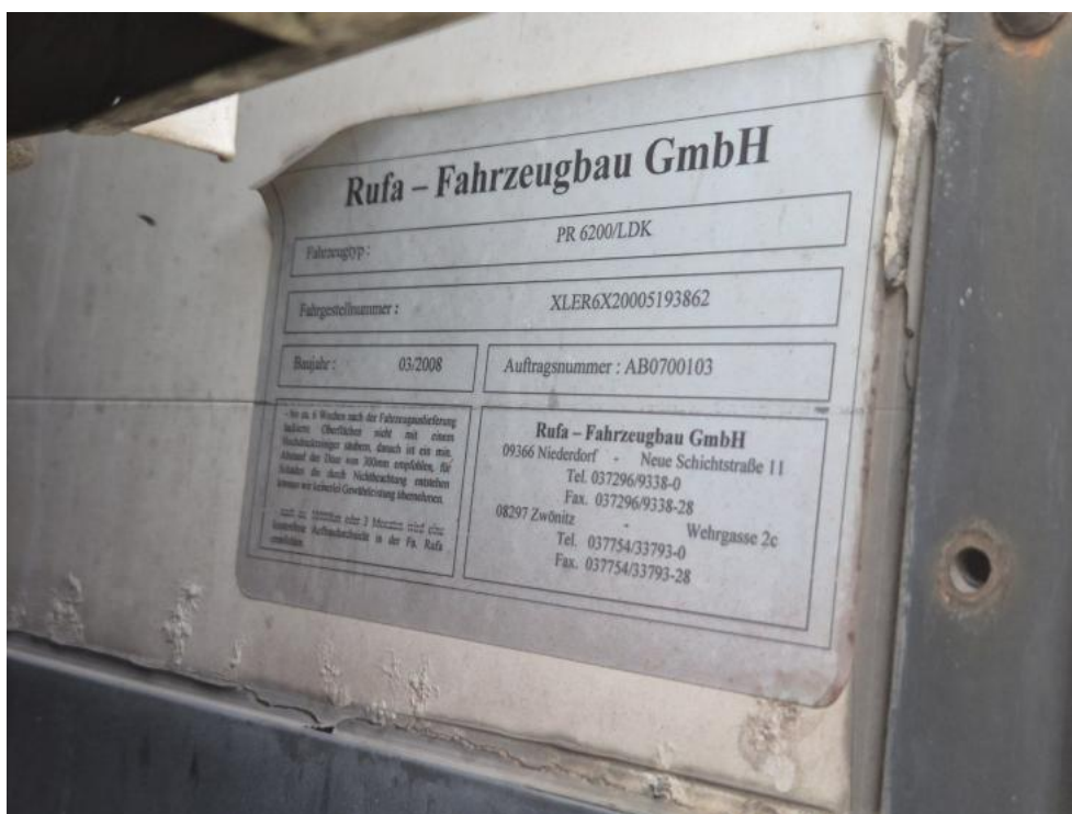
Fot. 30. Tabliczka znamionowa zabudowy
