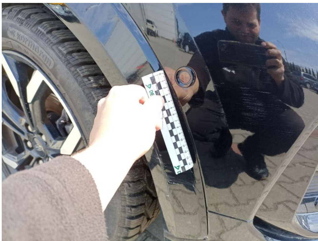
Fot. 34 Zderzak - Rysa/odprysk 1
