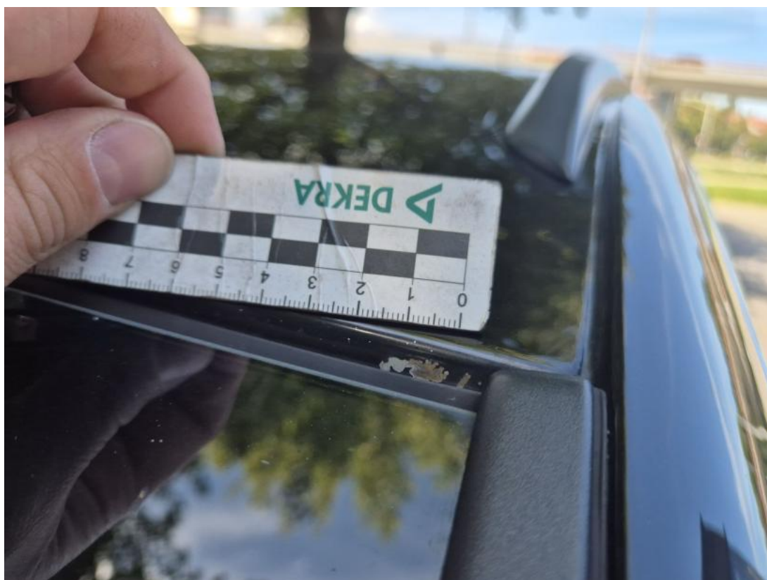
Fot. 62 Dach - Rysa/odprysk 1
