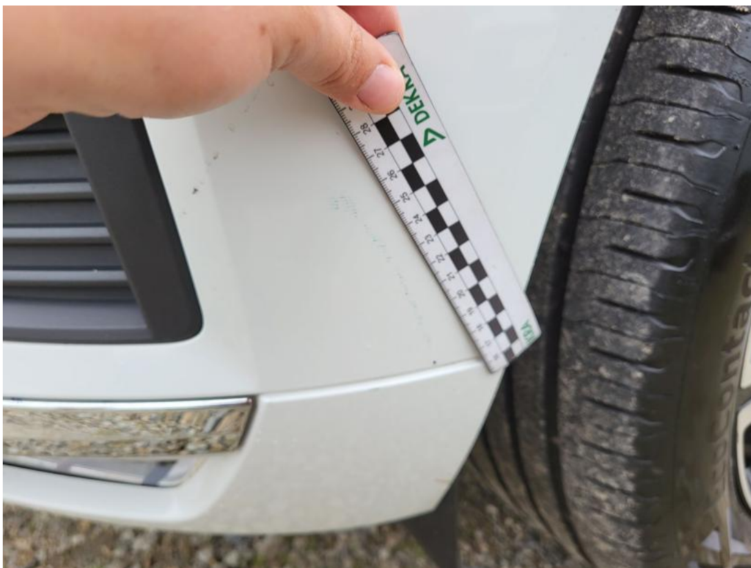
Fot. 37 Zderzak - Rysa/odprysk 1
