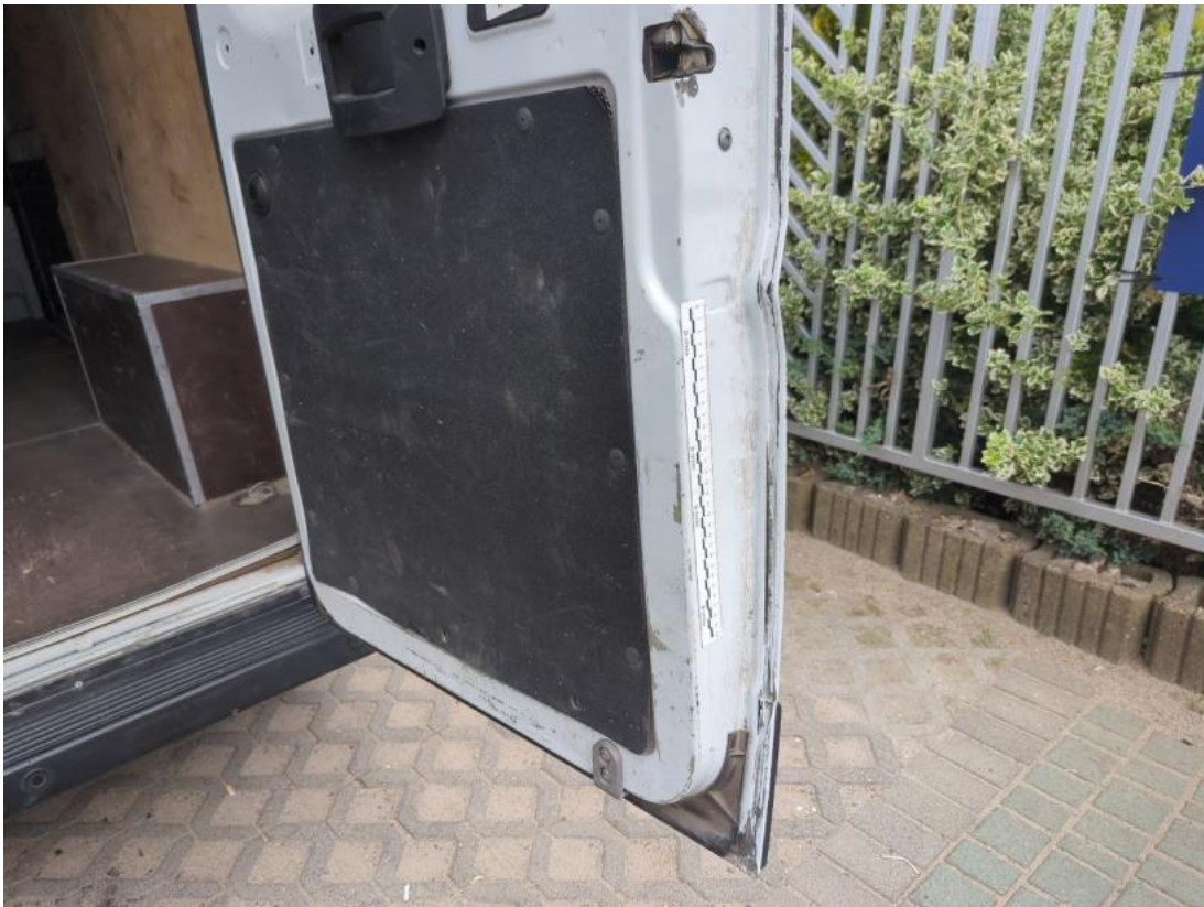
Fot. 111 Drzwi - Rysa/odprysk 2
