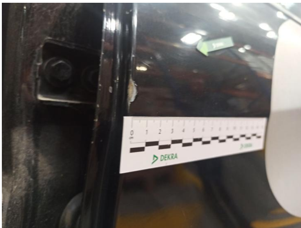
Fot. 63. Drzwi T L - korozja 1
