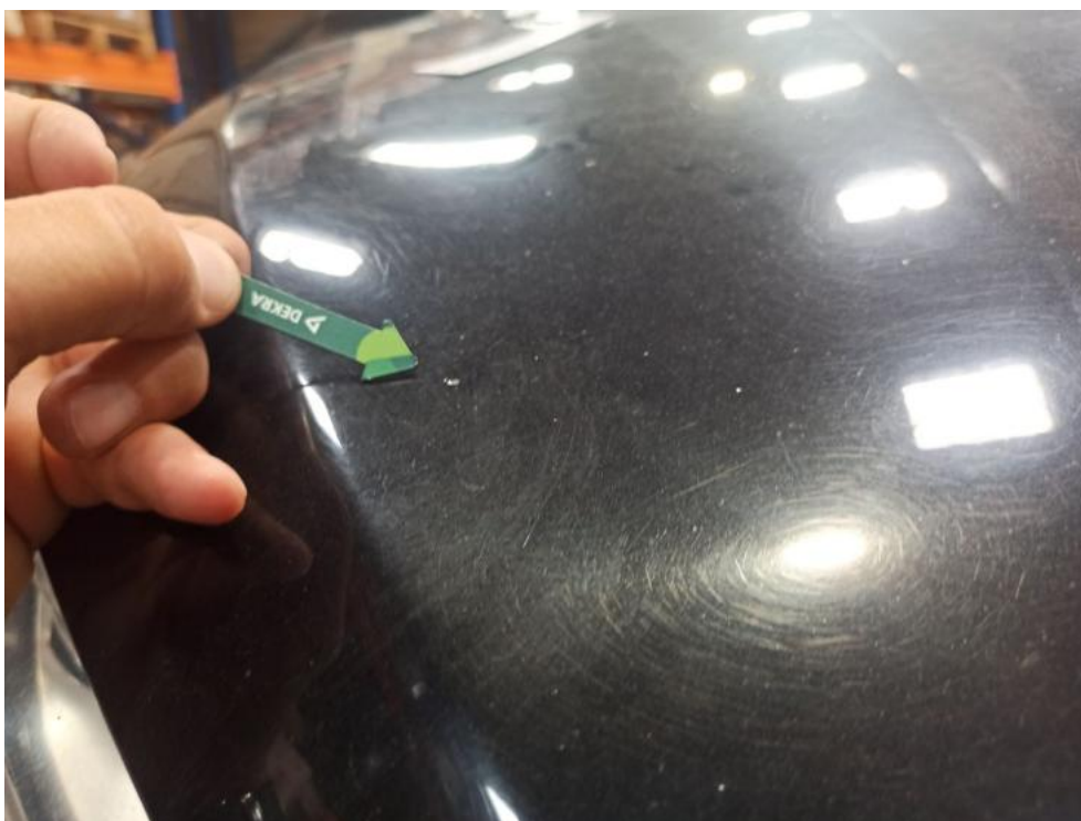
Fot. 46. Pokrywa() - odpryski lakieru 3
