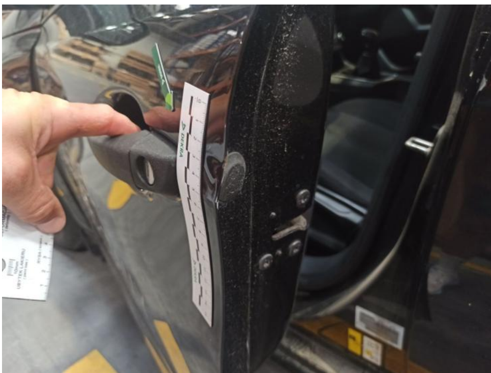
Fot. 61. Drzwi P L - deformacja 2
