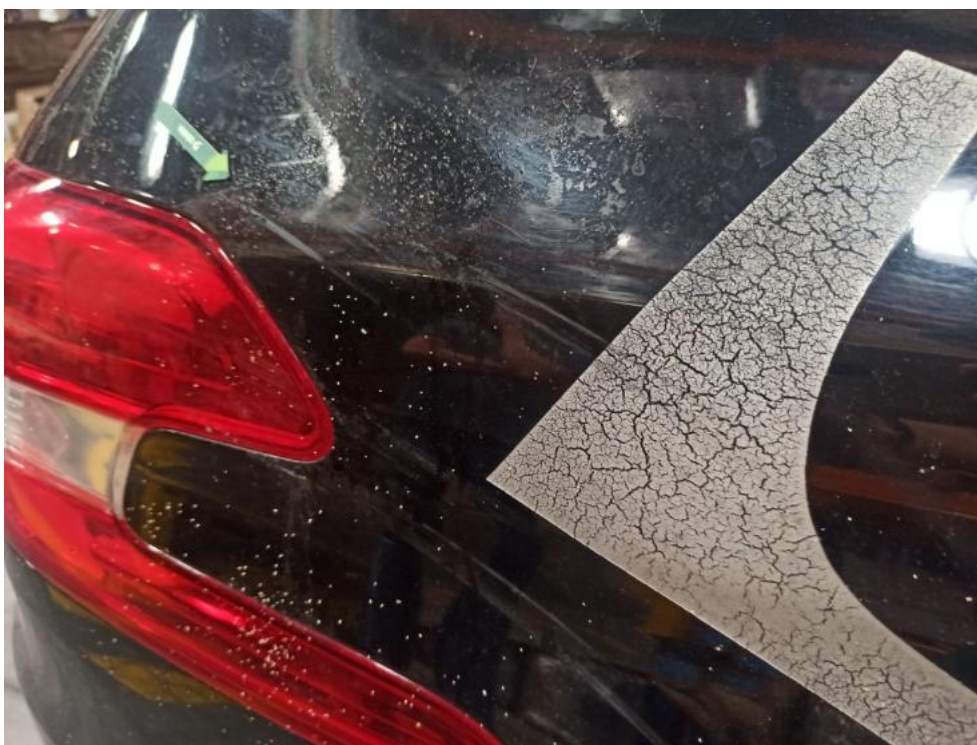
Fot. 35. Ściana boczna TP - zarysowanie 1
