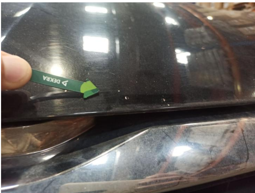
Fot. 45. Pokrywa - odpryski lakieru 2
