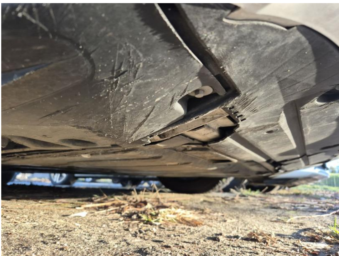
Fot. 32 Ostona dolna silnika - Pęknięcie/rozerwanie 1
