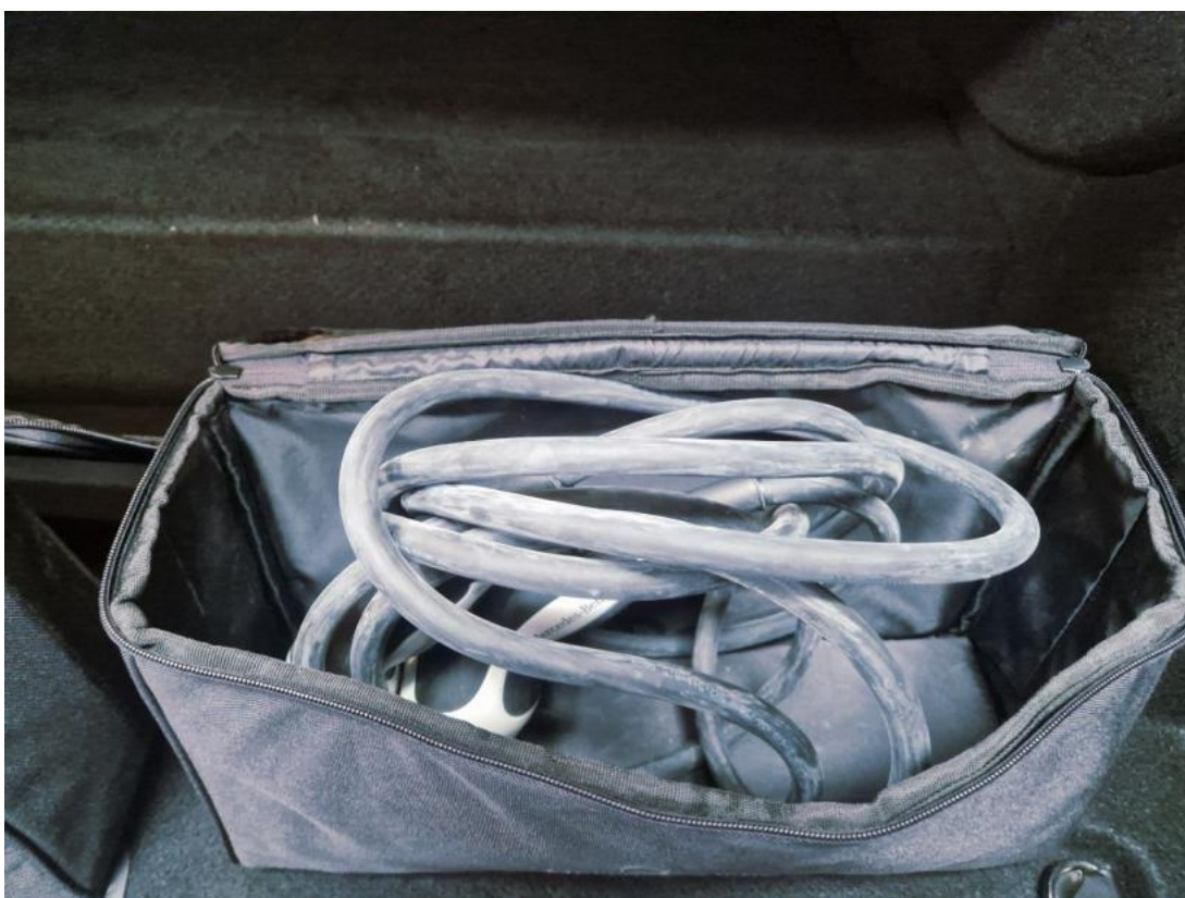
Fot. 28 Przewód ładowania baterii trakcyjnej
