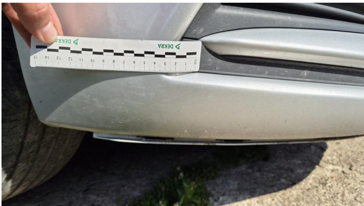
Fot. 38 Zderzak - Wgniecenie/odkształcenie 1
