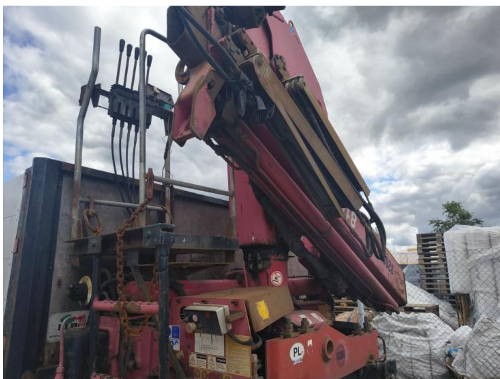
Fot. 46. Żuraw hydrauliczny - korozja 1
