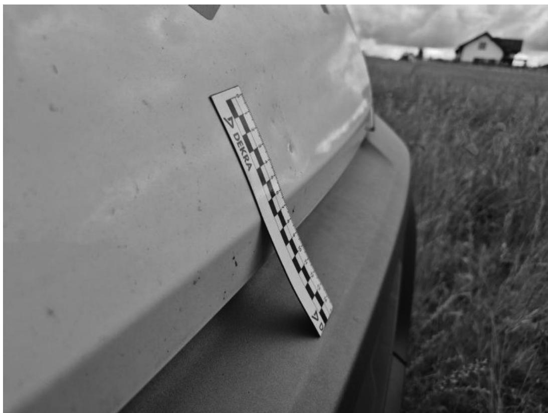
Fot. 36 Pokrywa komory silnika - Wgniecenie/odkształcenie 1
