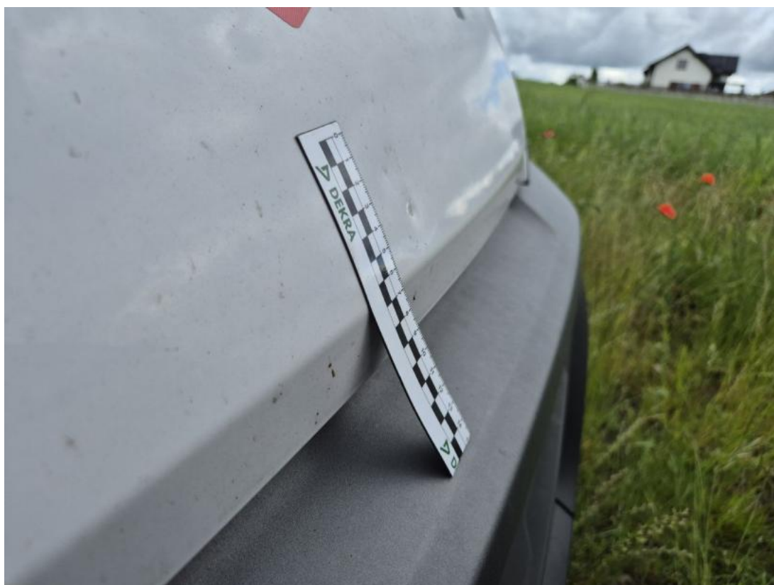
Fot. 36 Pokrywa komory silnika - Wgniecenie/odkształcenie 1
