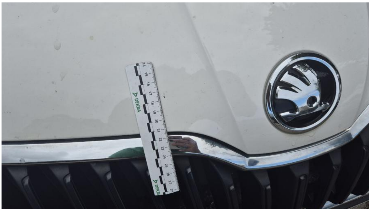
Fot. 38 Pokrywa komory silnika - Rysa/odprysk 1
