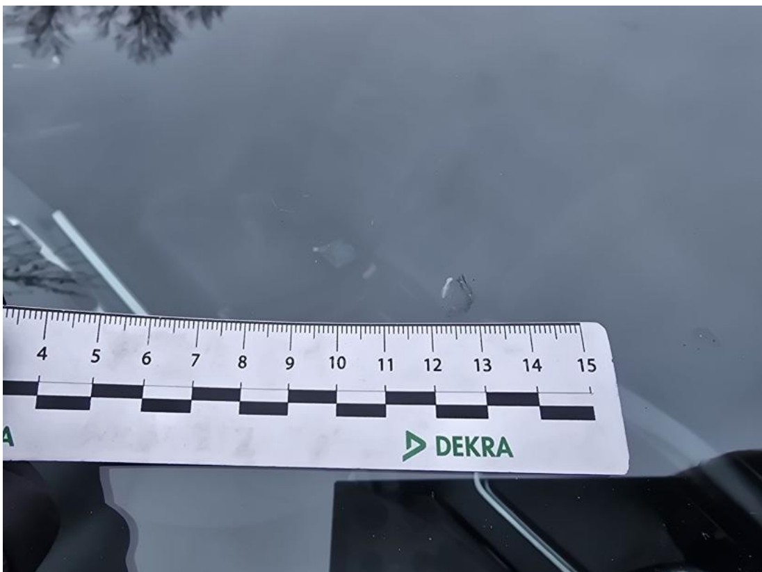
Fot. 38 Szyba czołowa - Rysa/odprysk 1
