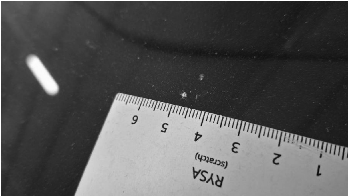
Fot. 38 Szyba czołowa - Rysa/odprysk 1
