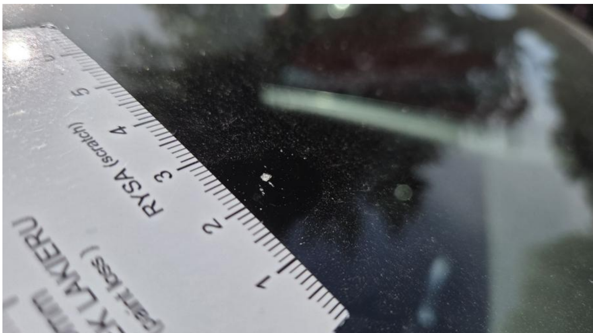
Fot. 36 Szyba czołowa - Rysa/odprysk 1
