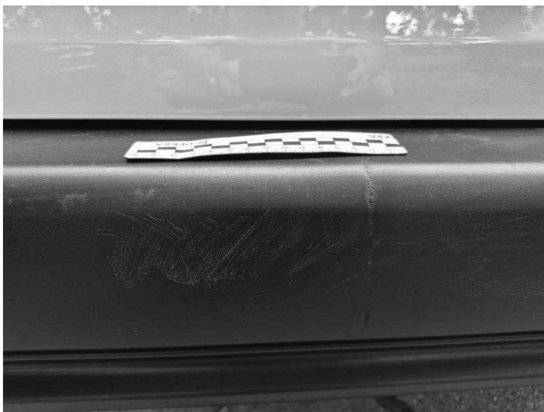
Fot. 48 Zderzak tylny - Rysa/odprysk 1
