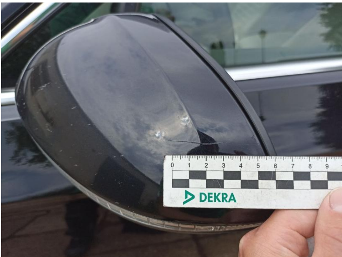
Fot. 54 Obudowa lusterka zew L - Rysa/odprysk 1
