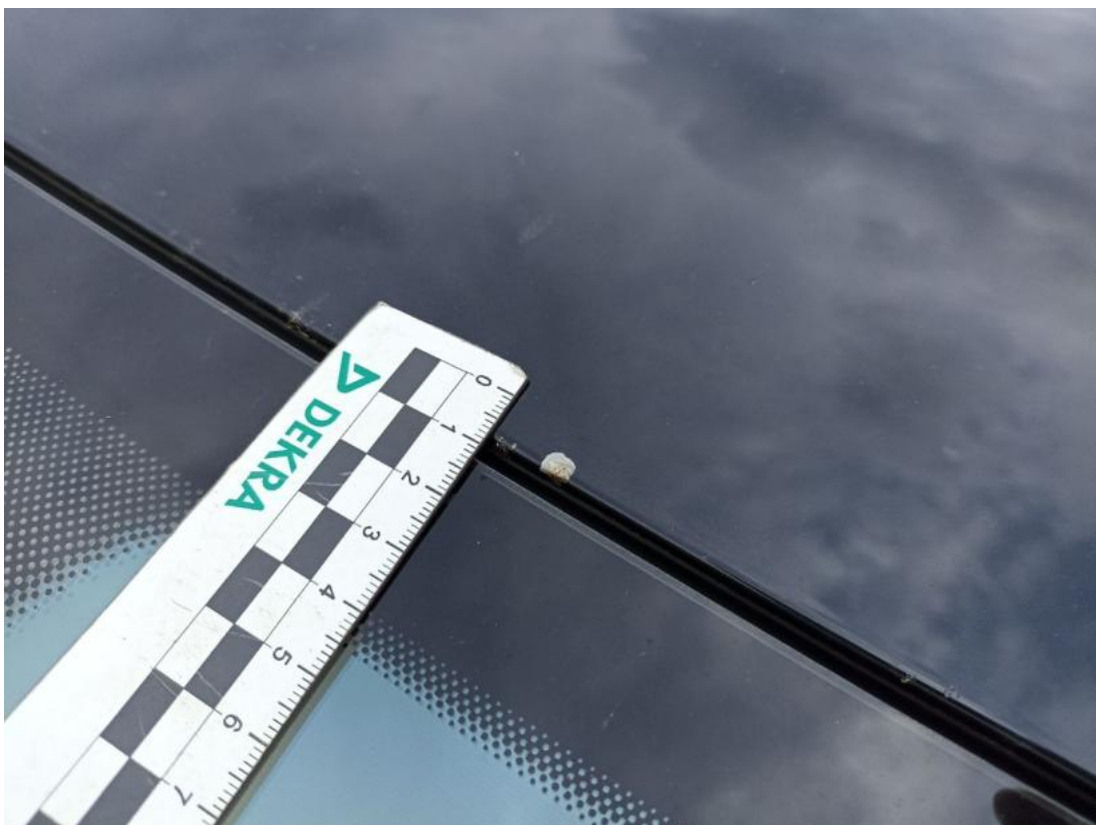
Fot. 50 Dach - Rysa/odprysk 1
