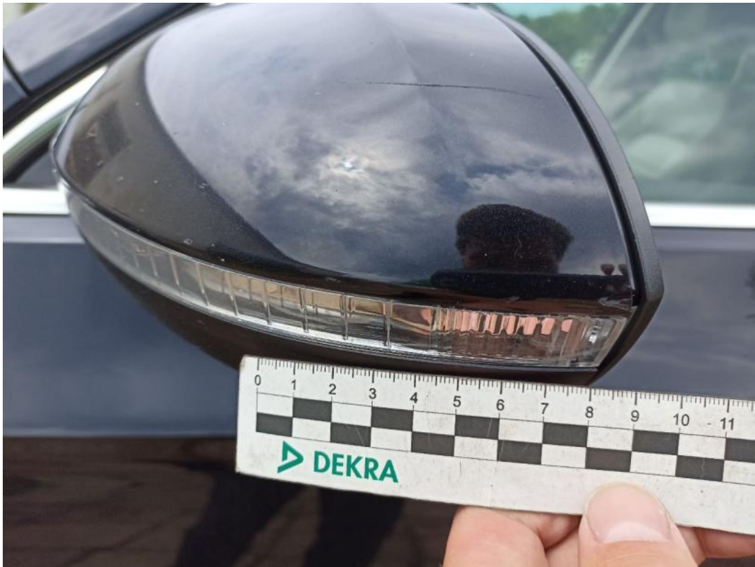
Fot. 55 Obudowa lusterka zew L - Rysa/odprysk 2
