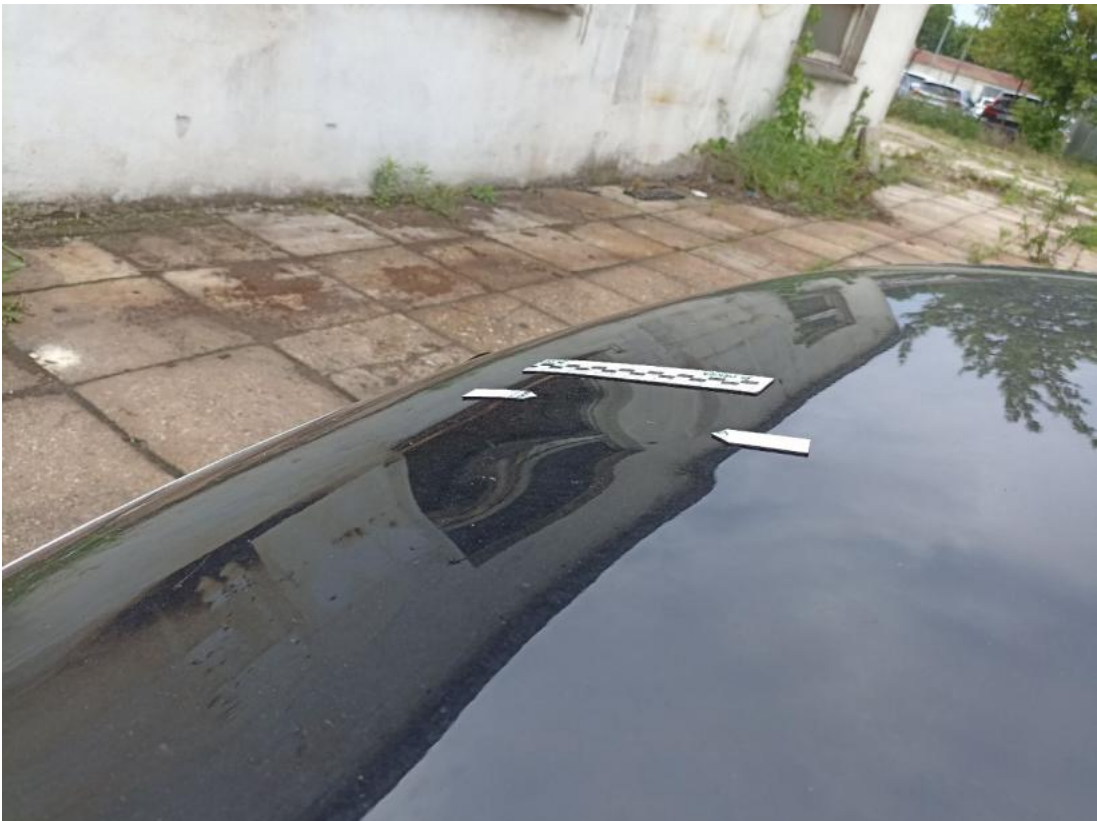
Fot. 37 Pokrywa komory silnika - Wgniecenie/odkształcenie 1
