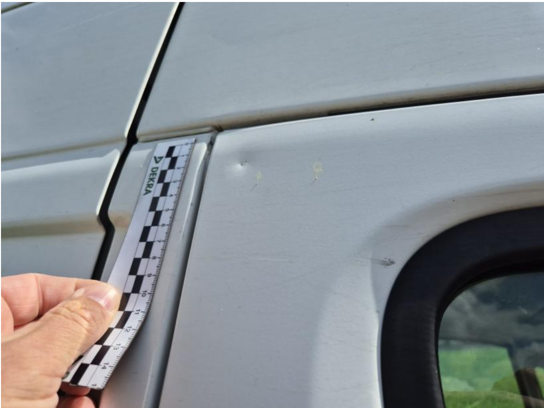
Fot. 43 Drzwi przednie P - Wgniecenie/odkształcenie 1
