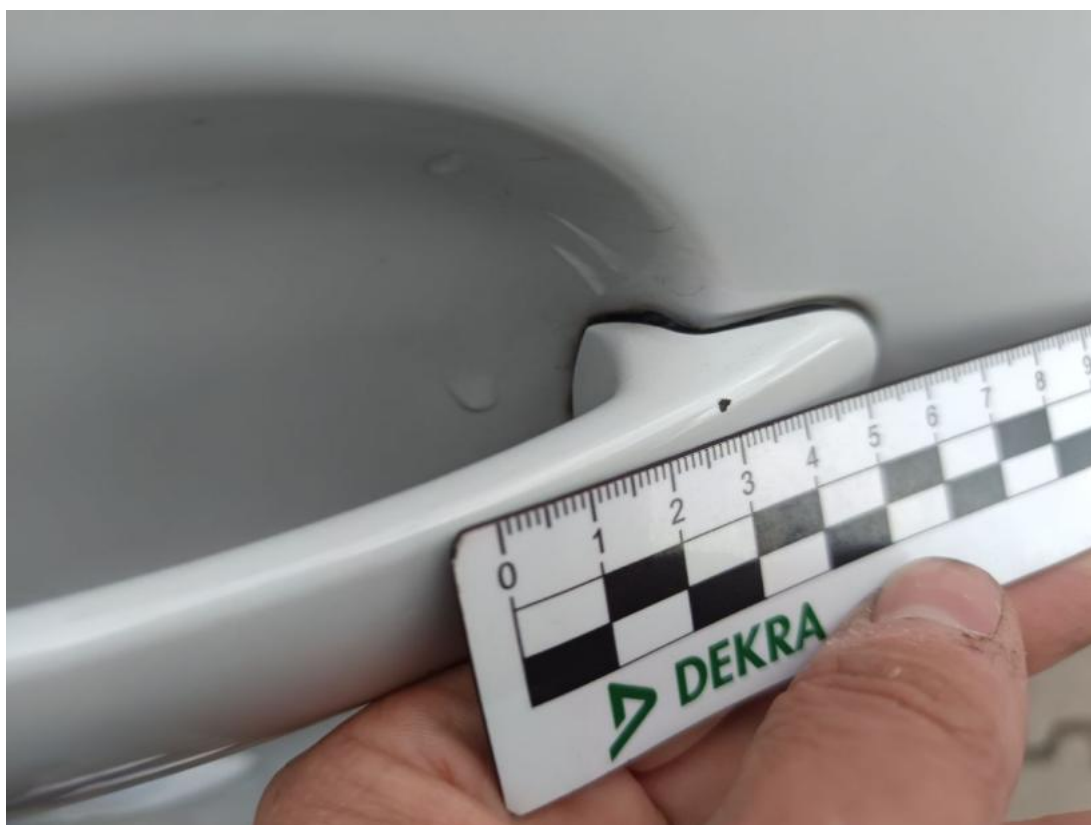
Fot. 42 Klamka drzwi prz P - Rysa/odprysk 1
