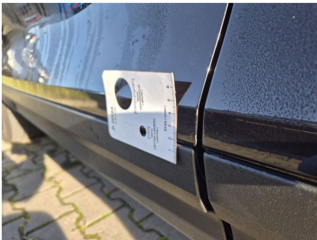
Fot. 45 Drzwi przed L - Rysa/odprysk 1
