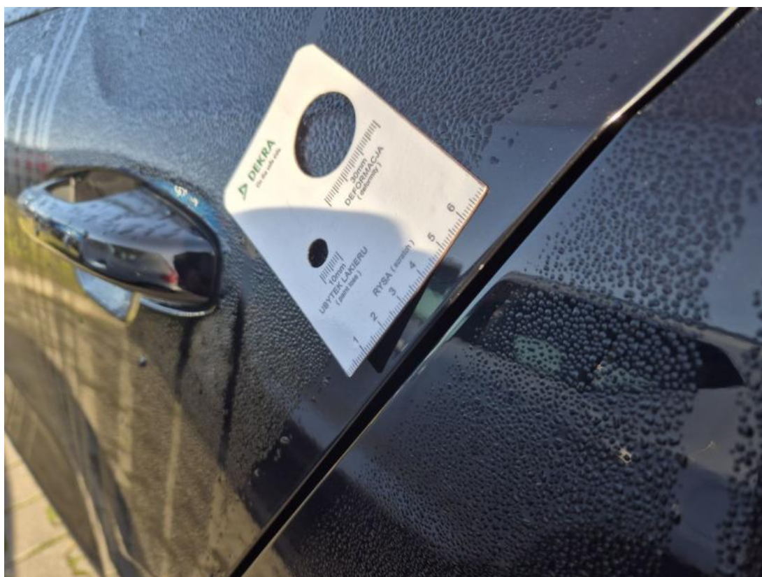
Fot. 47 Drzwi tylne L - Rysa/odprysk 1
