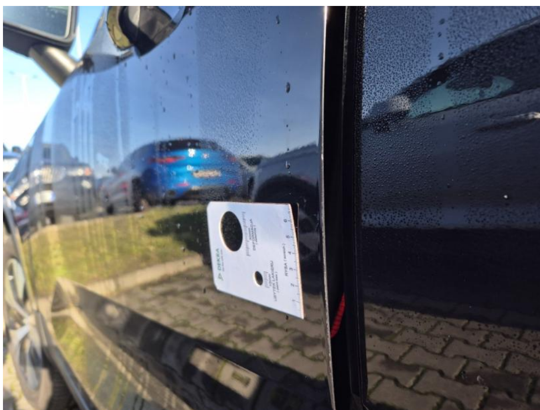
Fot. 46 Drzwi przed L - Rysa/odprysk 2
