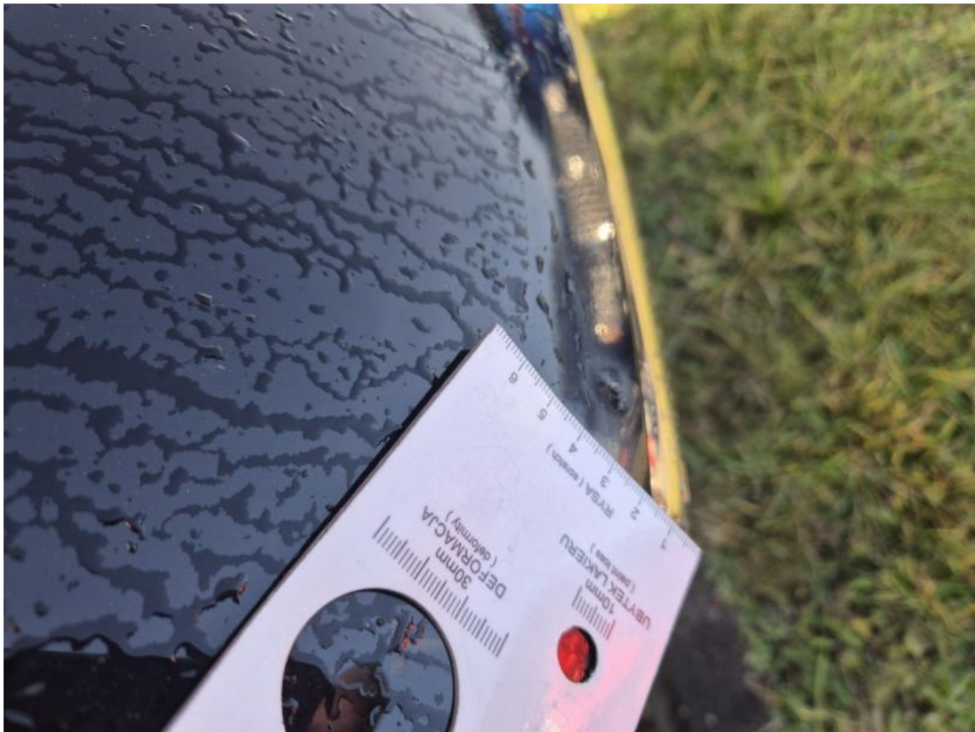
Fot. 37 Pokrywa komory silnika - Wgniecenie/odkształcenie 1
