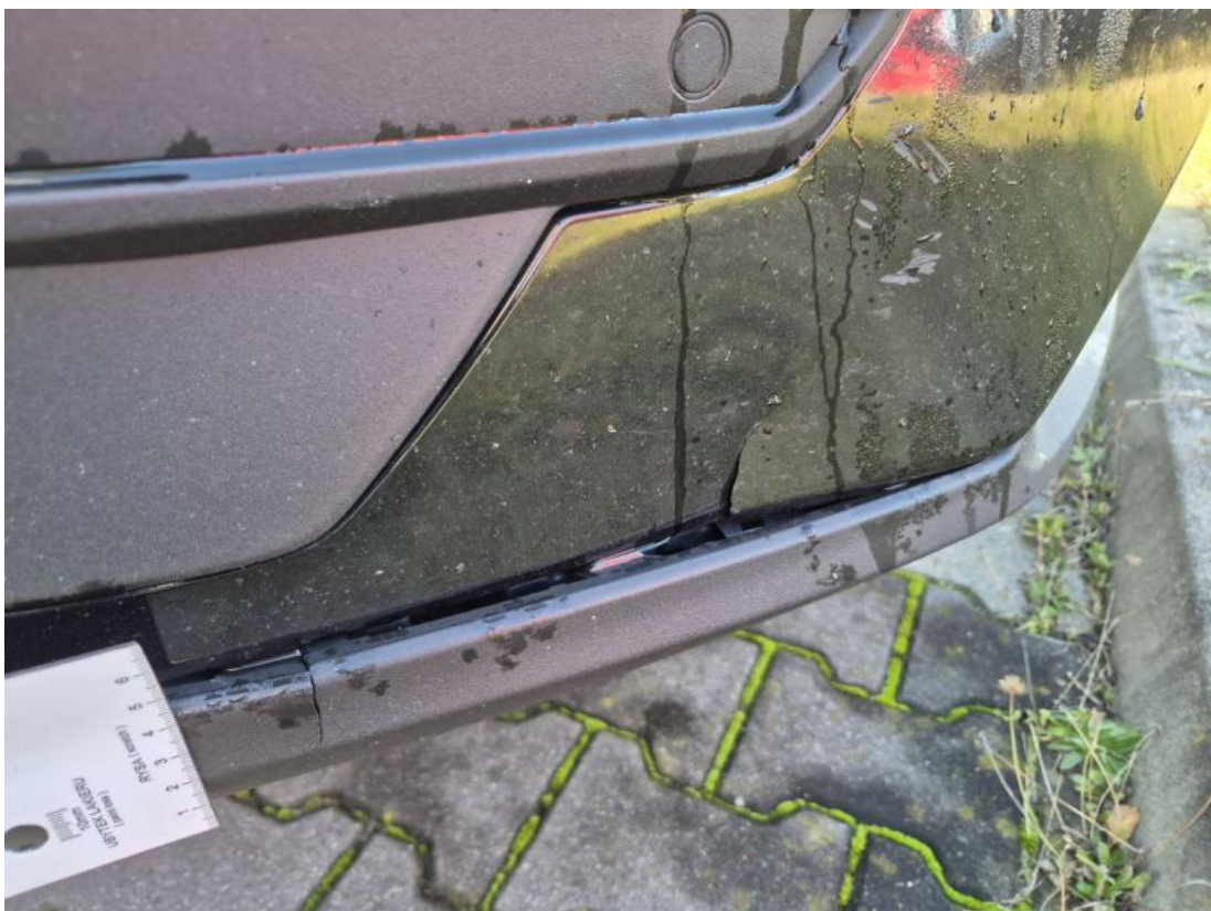
Fot. 38 Spoiler zderzaka przedniego - Pęknięcie/rozerwanie 1
