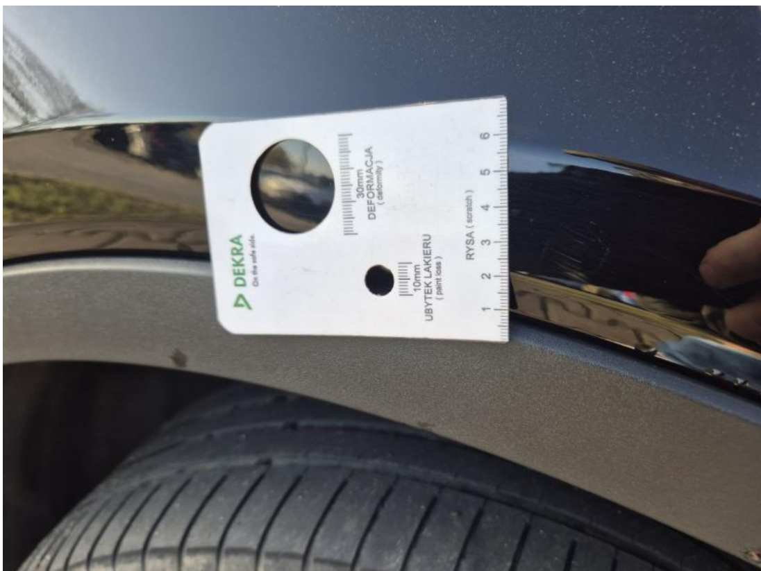
Fot. 42 Błotnik przedni P - Rysa/odprysk 1
