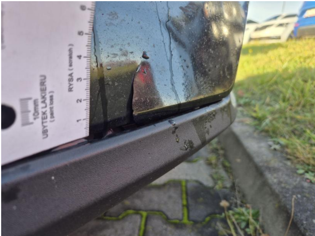
Fot. 41 Zderzak - Pęknięcie/rozerwanie 1
