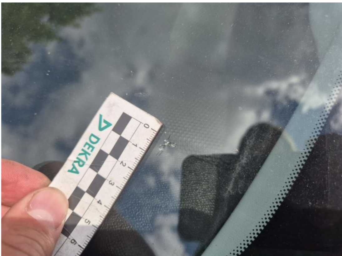
Fot. 36 Szyba czołowa - Pęknięcie/rozerwanie 1
