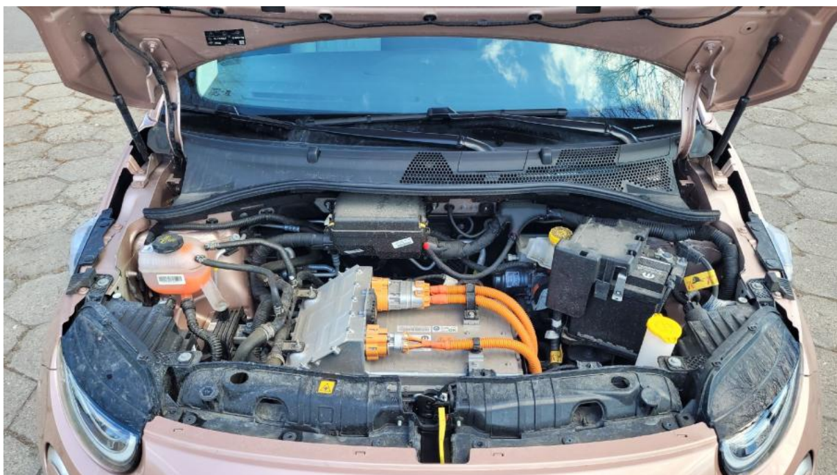
Fot. 23 Komora silnika
