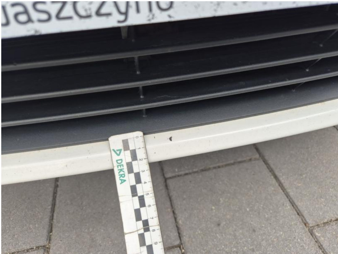
Fot. 35 Zderzak - Rysa/odprysk 1
