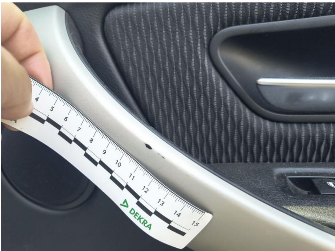
Fot. 74 Tapicerka drzwi tylnych P - Rysa/odprysk 1
