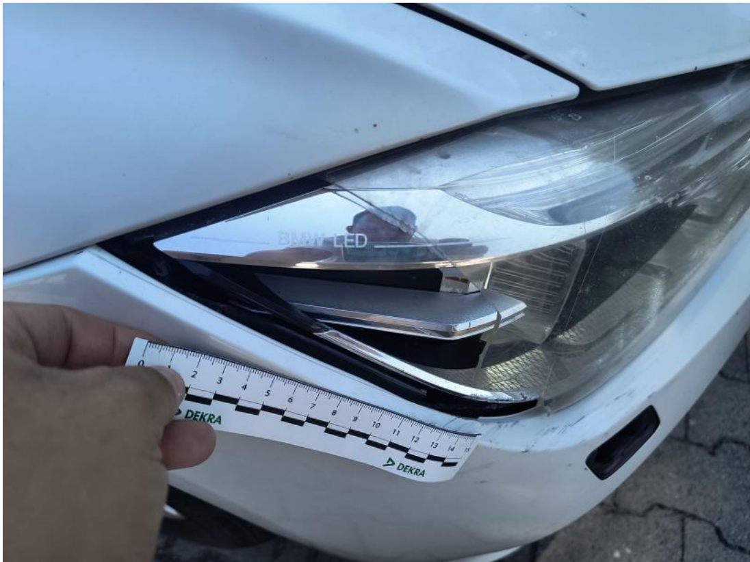
Fot. 53 Reflektor P - Pęknięcie/rozerwanie 1
