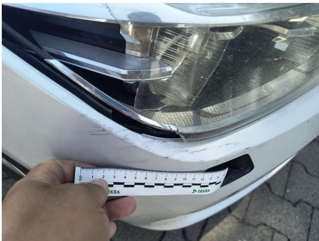
Fot. 50 Zderzak() - Rysa/odprysk 3
