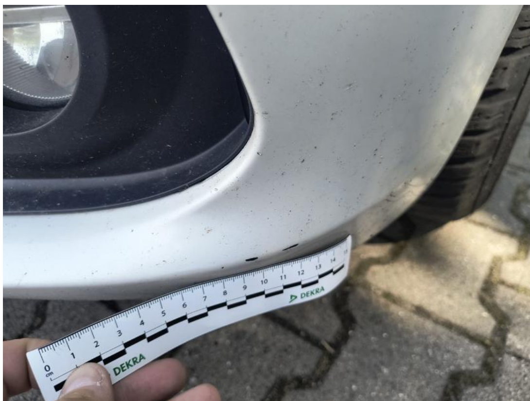
Fot. 49 Zderzak - Rysa/odprysk 2
