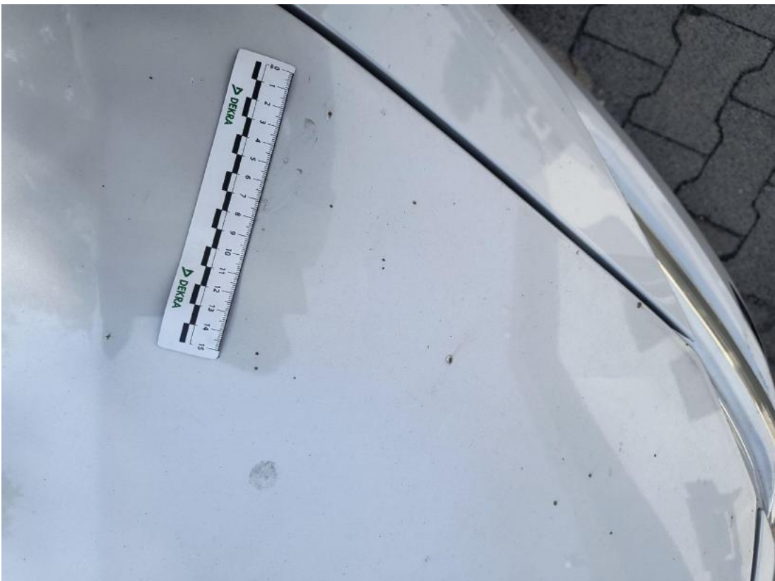
Fot. 42 Pokrywa komory silnika() - Rysa/odprysk 3
