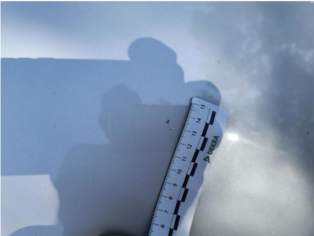
Fot. 41 Pokrywa komory silnika - Rysa/odprysk 2
