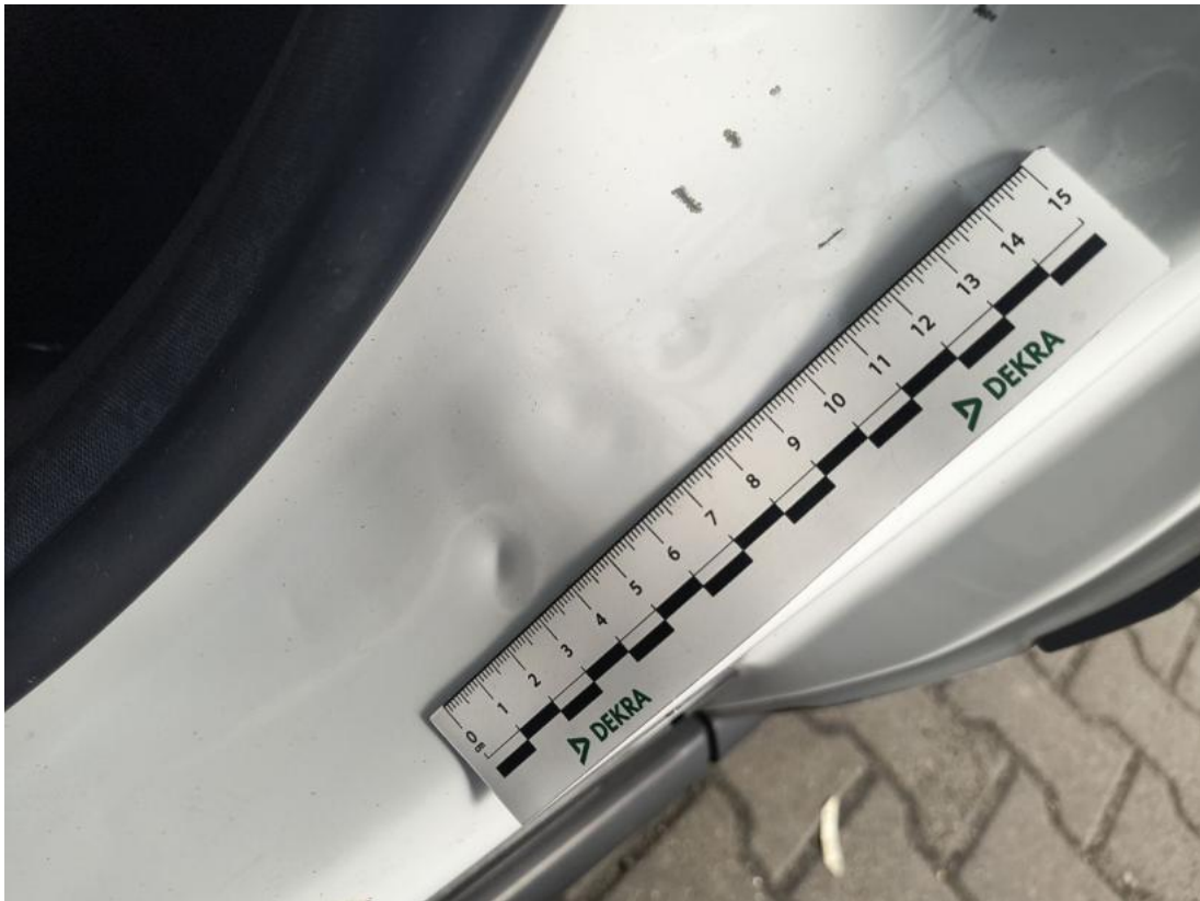
Fot. 89 Słupek środkowy L - Wgniecenie/odkształcenie 1
