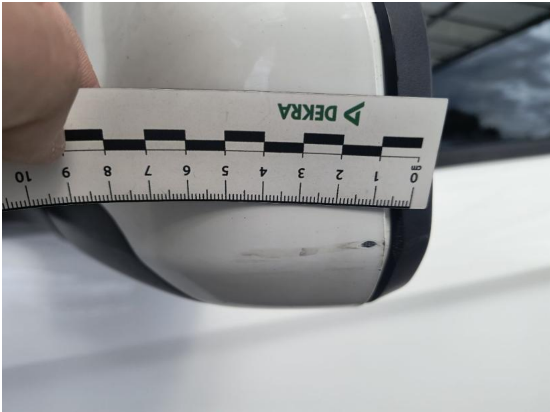
Fot. 83 Obudowa lusterka zew L - Rysa/odprysk 1
