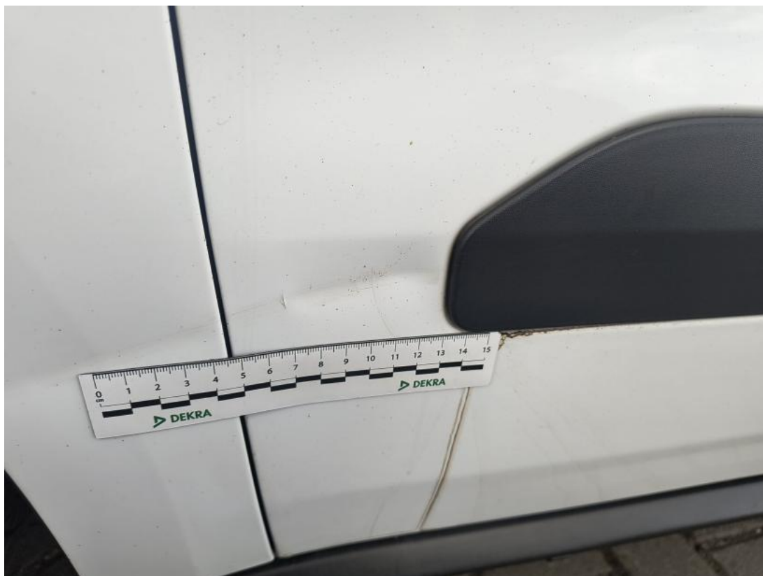
Fot. 81 Drzwi przed L - Wgniecenie/odkształcenie 1
