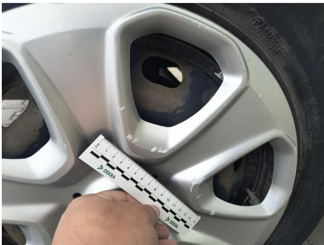
Fot. 63 Kołpak tylny P - Rysa/odprysk 2
