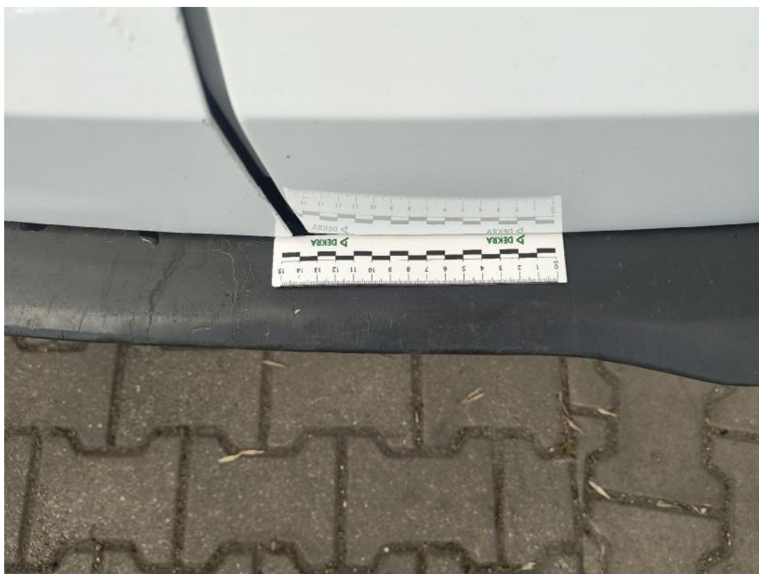
Fot. 72 Zderzak tylny - Wgniecenie/odkształcenie 1
