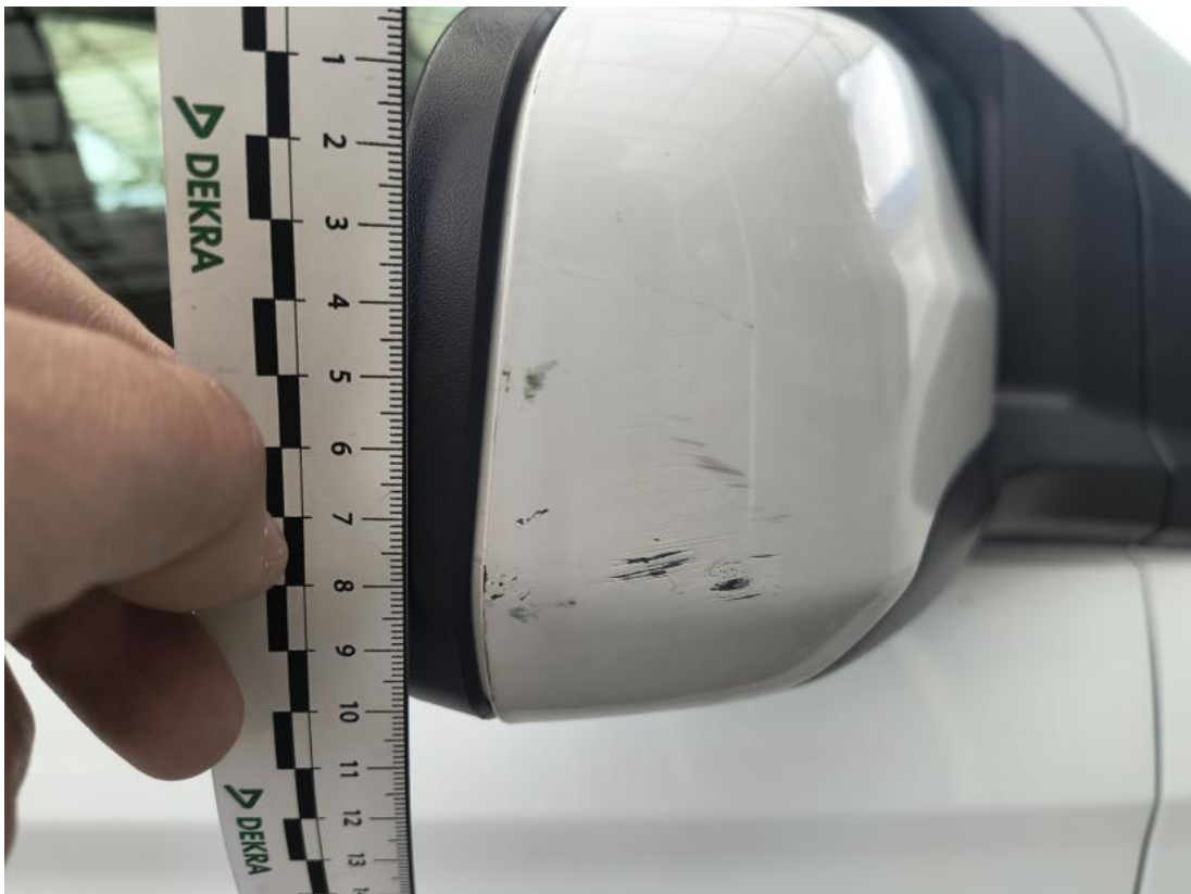
Fot. 53 Obudowa lusterka zew P - Rysa/odprysk 1
