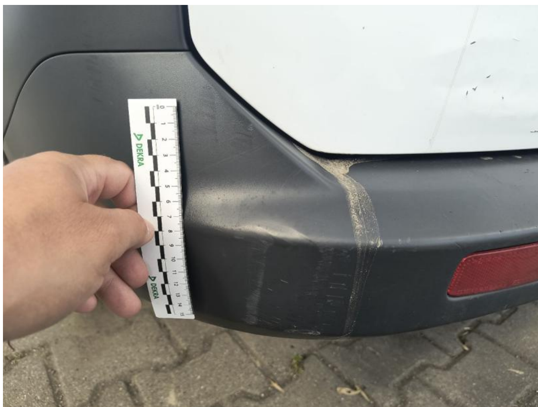
Fot. 71 Zderzak tylny - Rysa/odprysk 2
