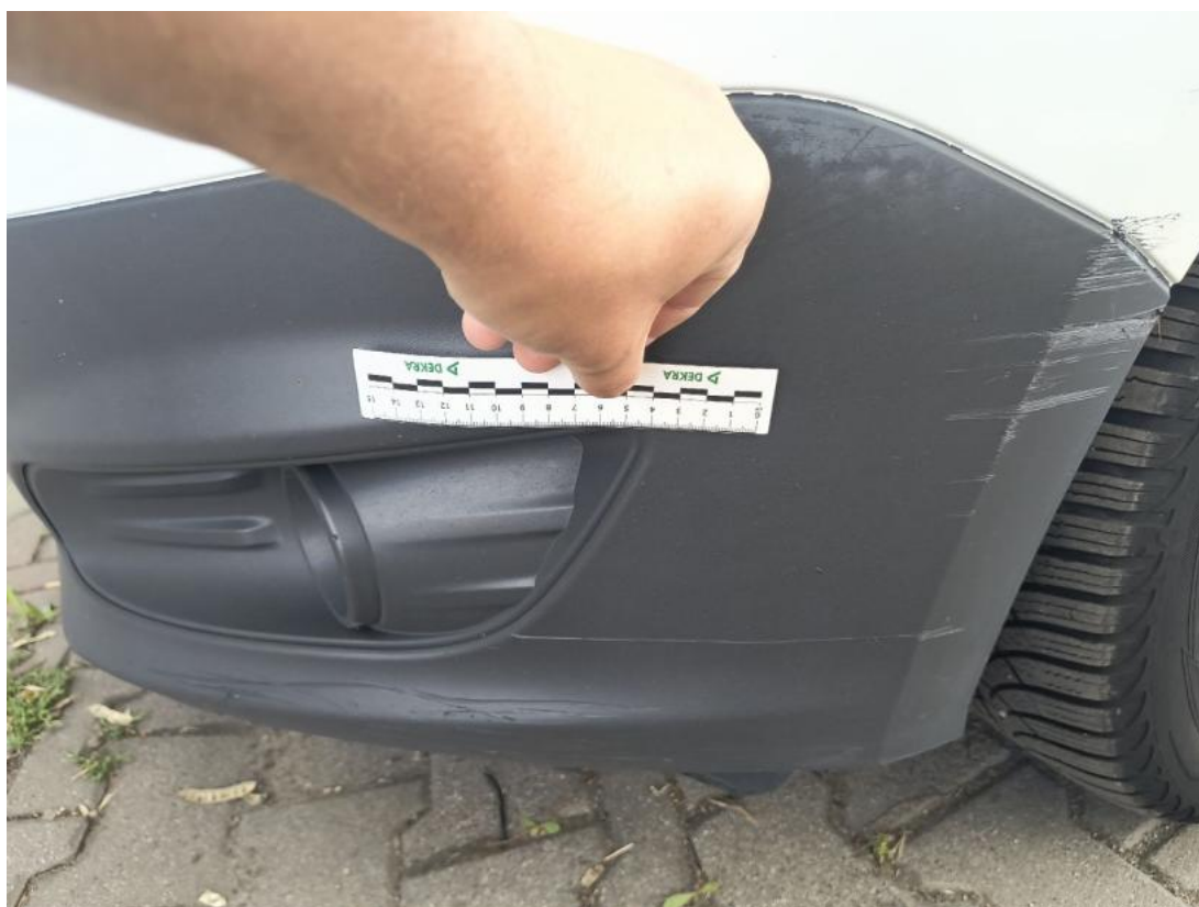
Fot. 44 Zderzak - Rysa/odprysk 2
