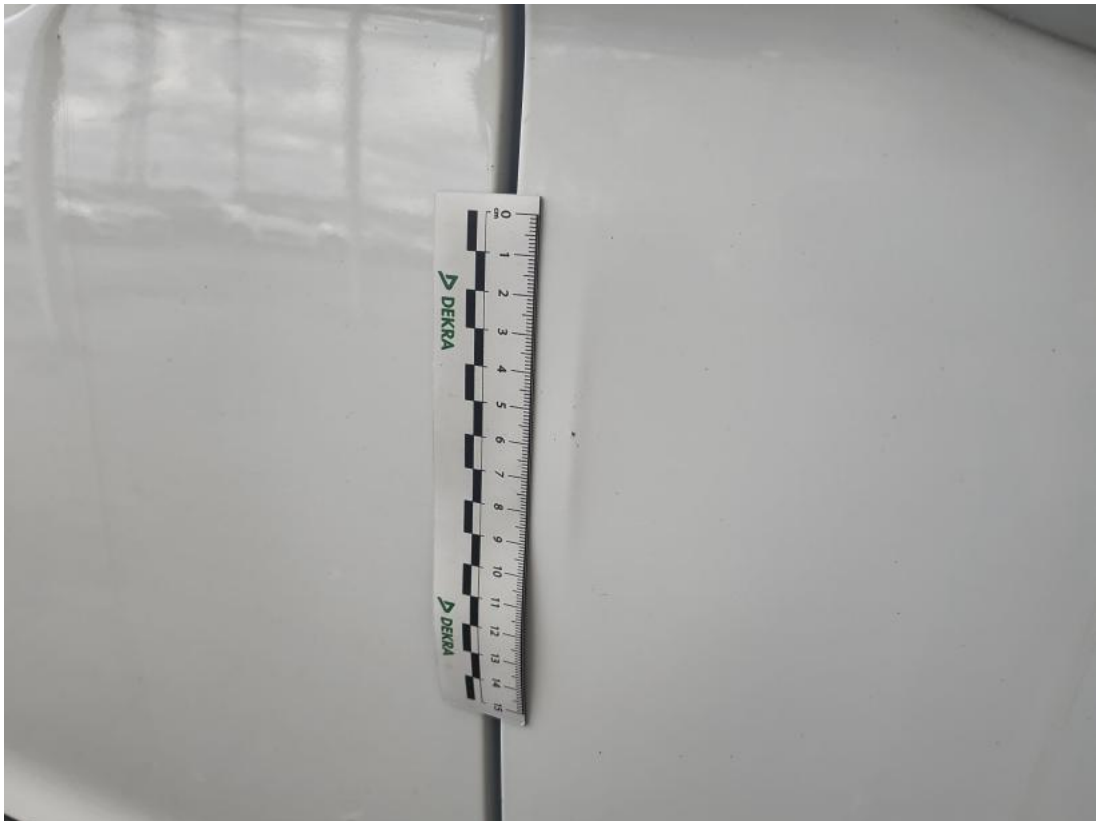
Fot. 49 Drzwi przednie P - Wgniecenie/odkształcenie 1
