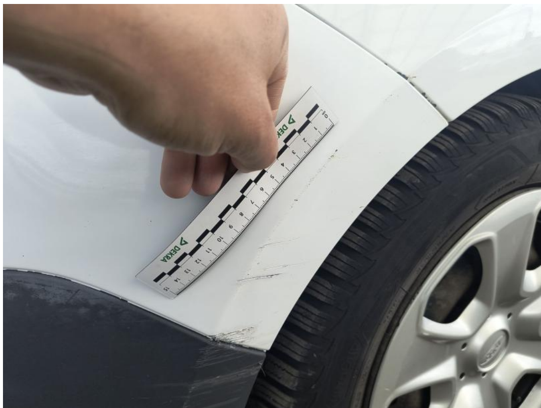
Fot. 43 Zderzak - Rysa/odprysk 1
