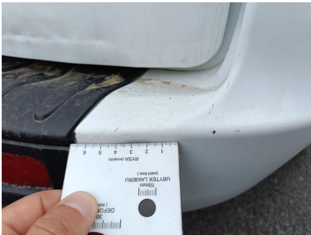
Fot. 51 Zderzak tylny cz śr - Wgniecenie/odkształcenie 1
