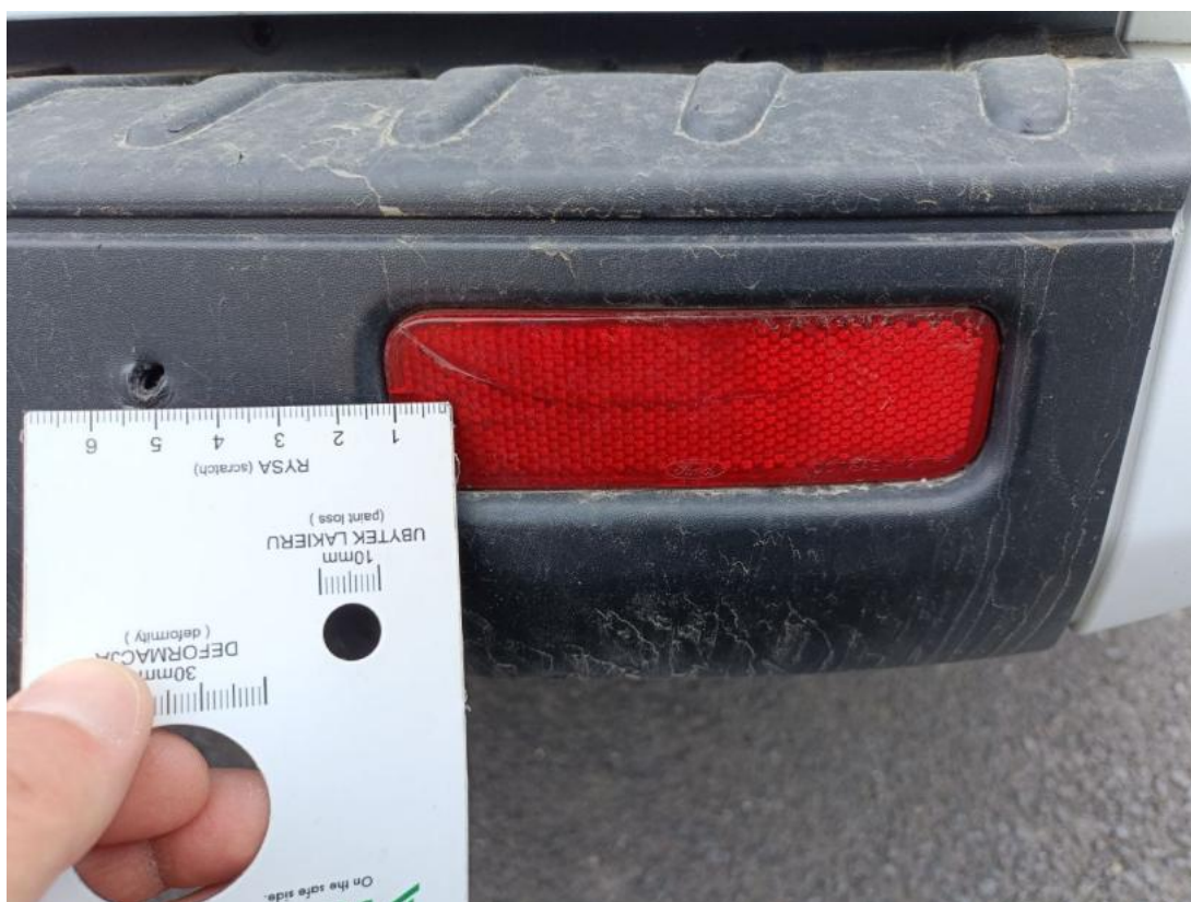
Fot. 54 Zderzak tylny cz őr - Pęknięcie/rozerwanie 2
