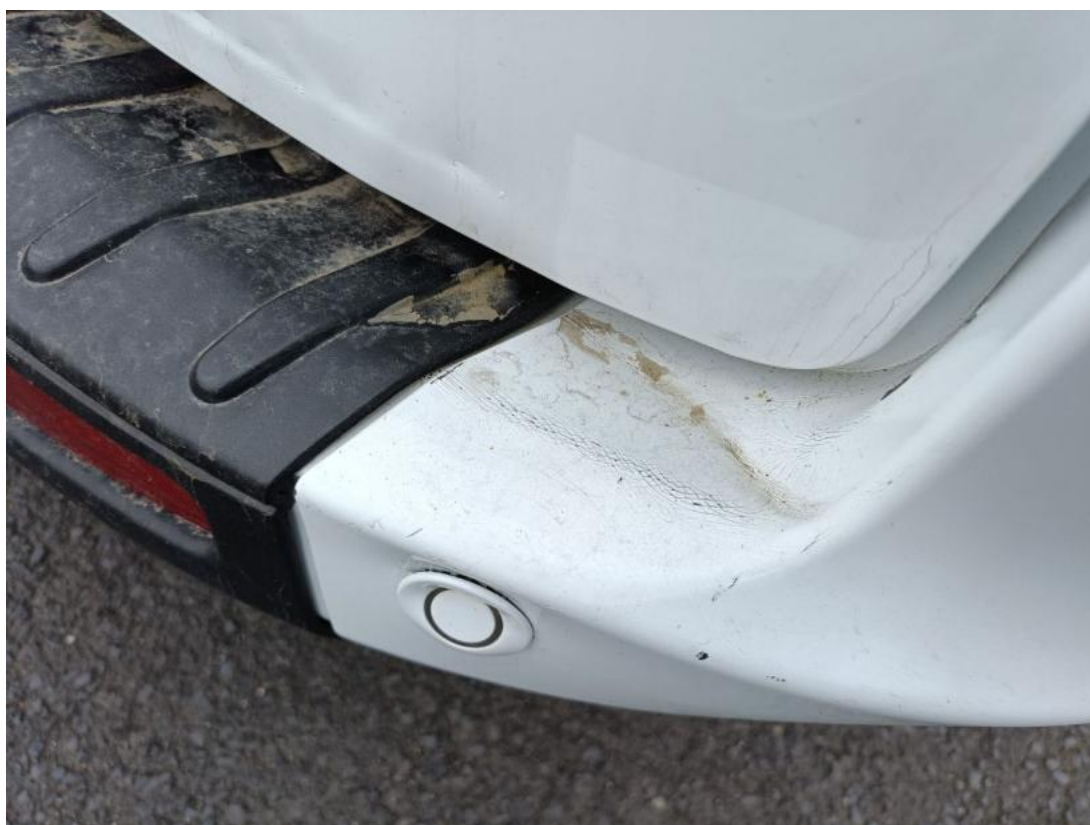
Fot. 52 Zderzak tylny cz śr() - Wgniecenie/odkształcenie 3
