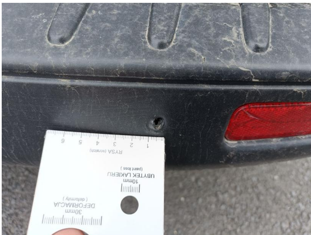
Fot. 53 Zderzak tylny cz őr - Pęknięcie/rozerwanie 1
