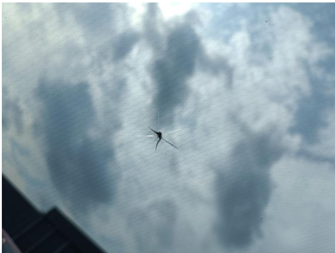
Fot. 41 Szyba czołowa() - Pęknięcie/rozerwanie 3
