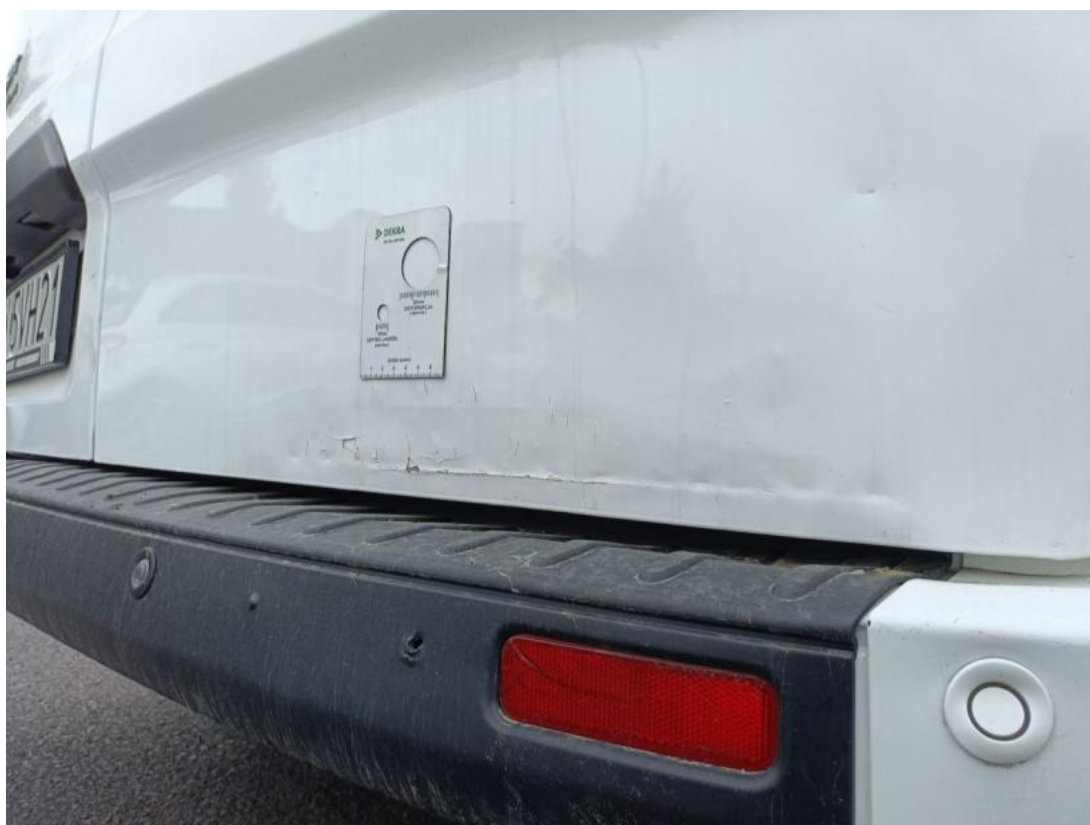
Fot. 44 Drzwi tylne P - Wgniecenie/odkształcenie 1
